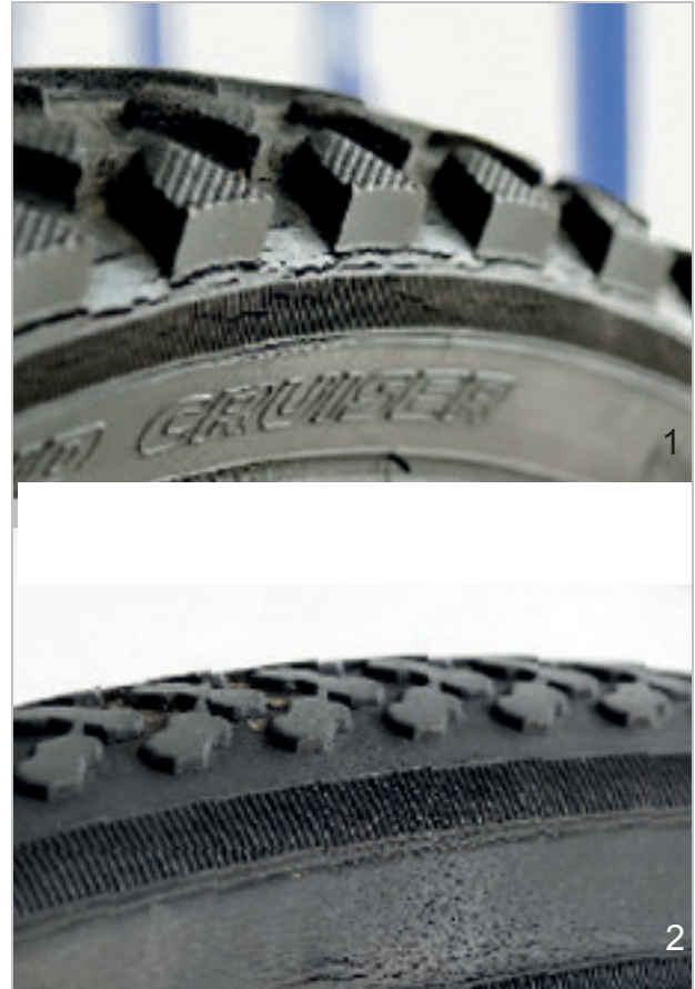
Abbildung 103: Beispiele für Ermüdungsrisse (1) und Alterungsrisse (2)
