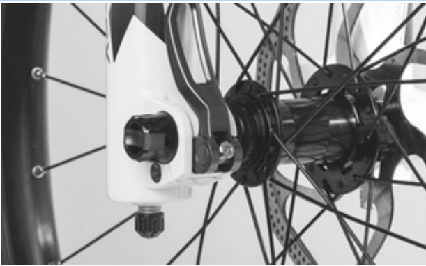
Figura 63: Corretta posizione della leva di serraggio
