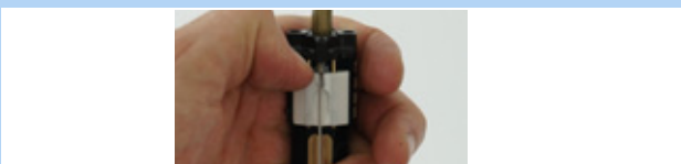
Figura 177: Spinta del cursore di azionamento bianco verso il basso
