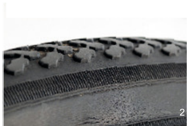
Figura 139: Esempi di crepe da fatica (1) e da invecchiamento (2)
