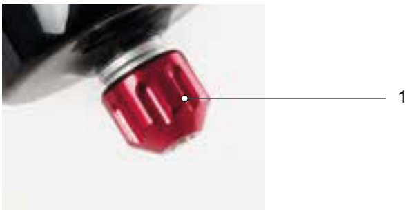
Figura 214: Vite del rebound Suntour (1)
