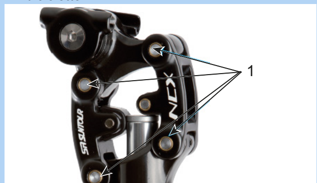
Figura 150: Punti di lubrificazione del cannotto reggisella ammortizzato SR Suntour
