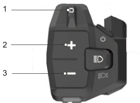
Figura 112: Ubicazione interruttore a bilico (1), pulsante più (2) e pulsante meno (3)
