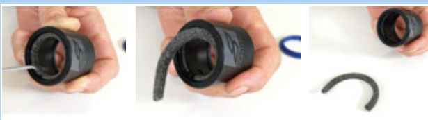
Figura 197: Rimozione dell'anello di feltro
