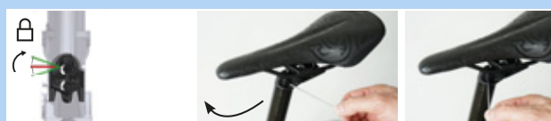
Figura 188: Chiusura della regolazione in altezza
