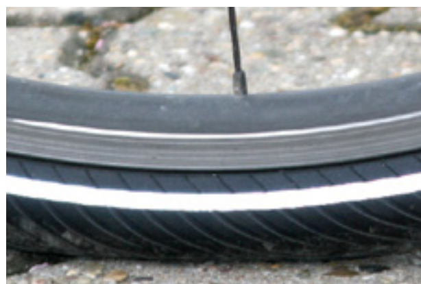
Figura 91: Corretta pressione di gonfiaggio. Lo pneumatico quasi non si deforma sotto il peso corporeo
