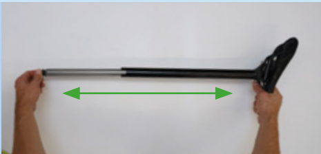
Figura 203: Estrazione completa del tubo del canotto reggisella
