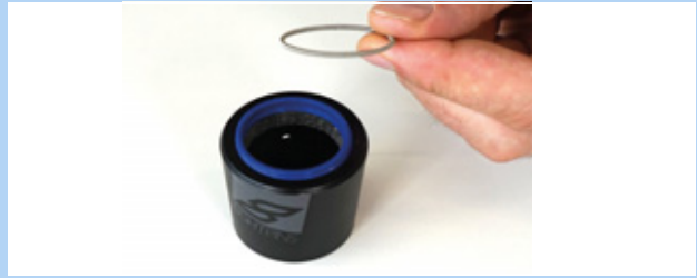
Figura 160: Anello elastico smontato
