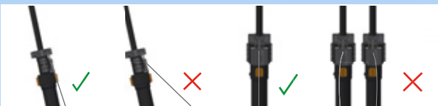
Figura 178: Cavo meccanico corretto ed errato
