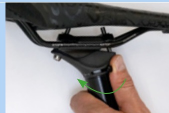
Figura 207: Chiusura della regolazione in altezza
