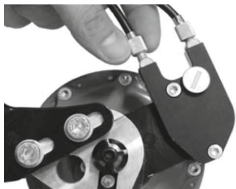
Figura 144: Le versioni del mozzo Rohloff con comando esterno del cambio hanno i regolatori del tensionamento sulla scatola dei cavi situata sul lato sinistro
