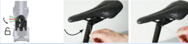
Figura 151: Posizionamento dell'azionamento della regolazione in altezza in posizione orizzontale
