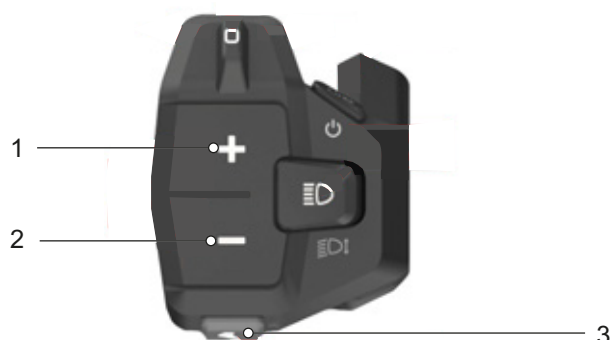
Figura 125: Ubicazione pulsante più (1), pulsante meno (2) e pulsante della funzione di assistenza di spinta (3)
