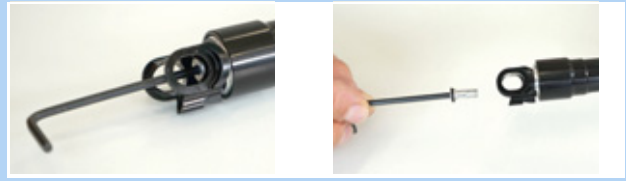
Figura 167: Svitamento del cappuccio della valvola
