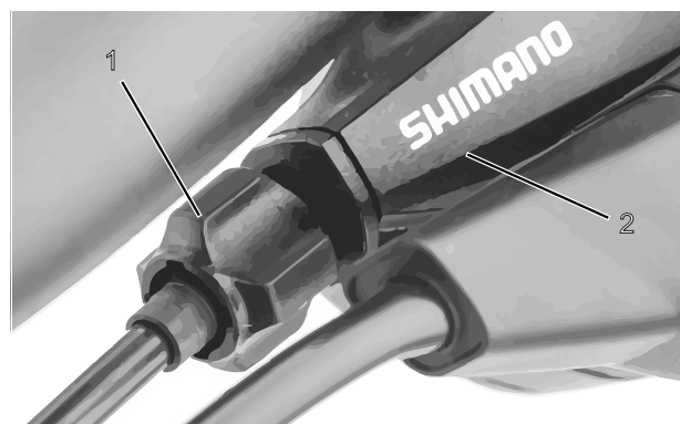
Figura 145: Boccola di regolazione (1) del cambio azionato da cavo singolo con scatola della leva del cambio (2), esempio
