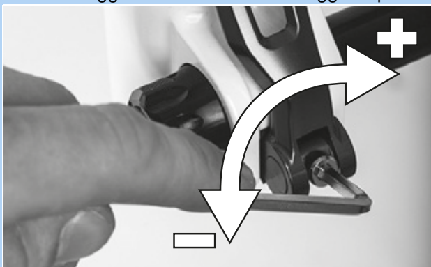
Figura 149: Regolazione della forza di serraggio del bloccaggio rapido
