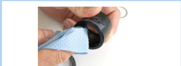
Figura 163: Pulizia della boccola esterna
