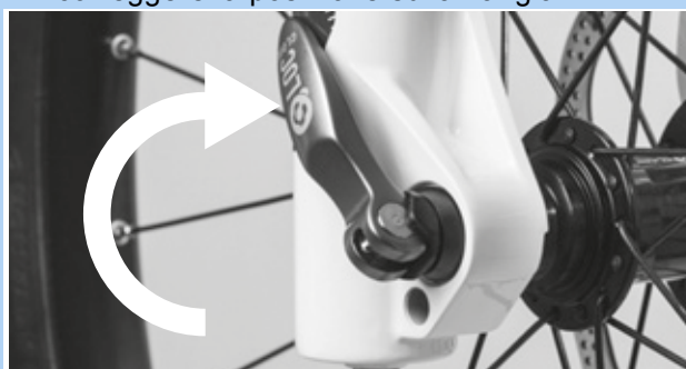
Figura 68: Chiusura del bloccaggio rapido
