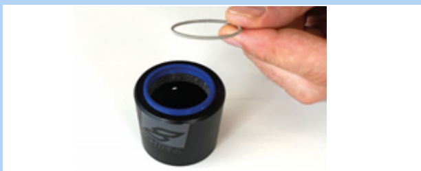
Figura 195: Anello elastico smontato
