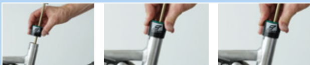
Figura 183: Applicazione della boccola esterna
