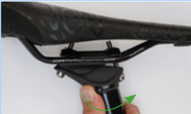
Figura 202: Apertura della regolazione in altezza
