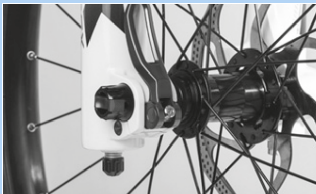
Figura 148: Regolazione della forza di serraggio del bloccaggio rapido
