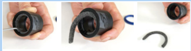
Figura 162: Rimozione dell'anello di feltro
