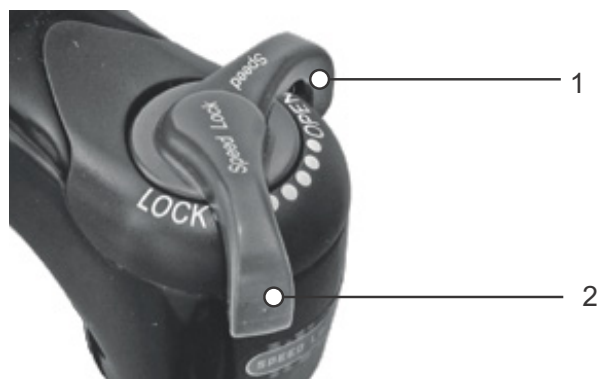
77. ábra: Suntour nyomásfokozat-lengéscsillapító nyitott (1) és zárt (2) helyzetben
