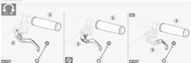
51. ábra: Magura tárcsafék fékkar markolási szélességének beállítása
