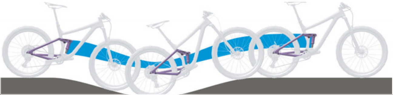
101. ábra: A hátsó lengéscsillapító túl puha rugózása hegymenetben
