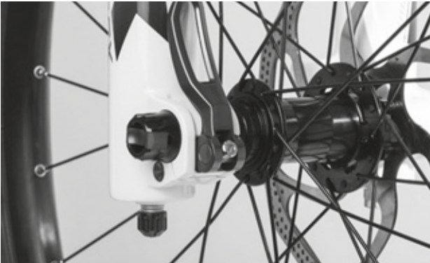
84. ábra: A gyorsár szorítóerejének beállítása
