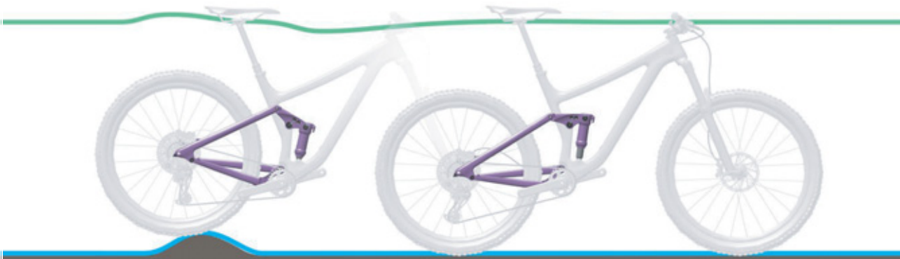
69. ábra: A hátsó lengéscsillapító optimális menetviselkedése egyenetlenségeknél
