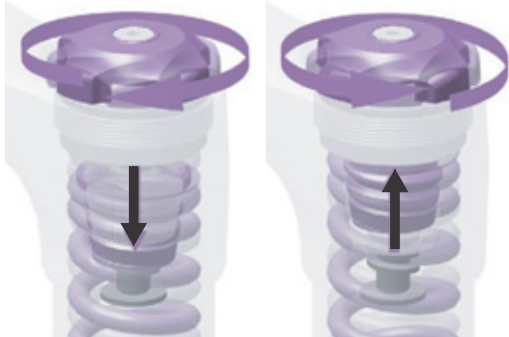
55. ábra: Előfeszítés-beállítógyűrű befelé és kifelé forgatása.
