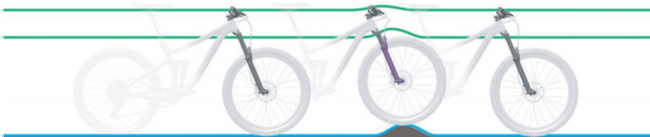
7. ábra: A villa optimális menetviselkedése egyenetlenségek esetén
