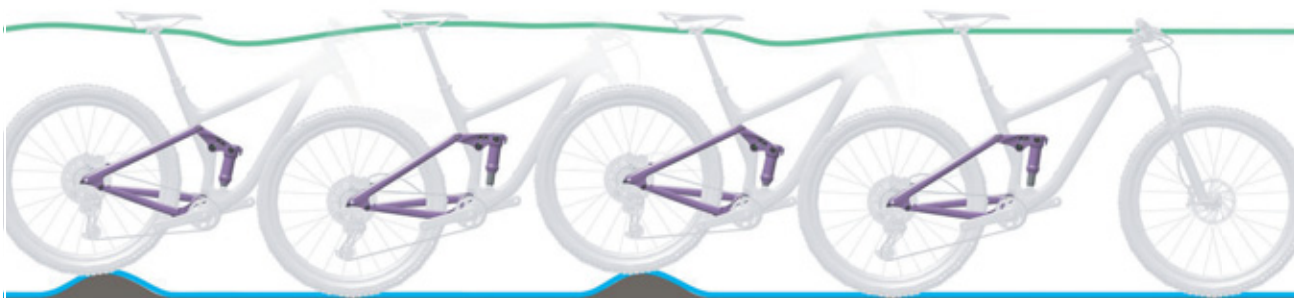
62. ábra: A hátsó lengéscsillapító optimális menetviselkedése
