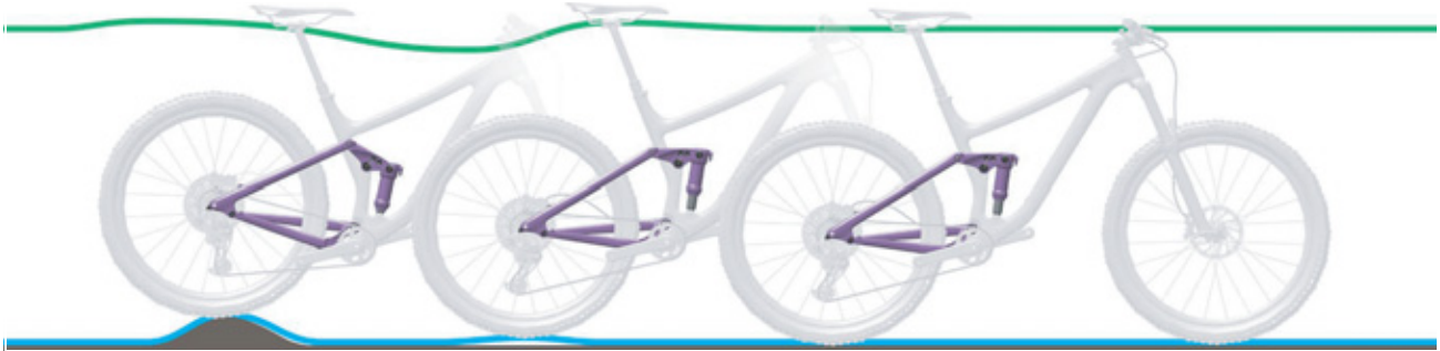
97. ábra: A hátsó lengéscsillapító túl gyors kirugózása
