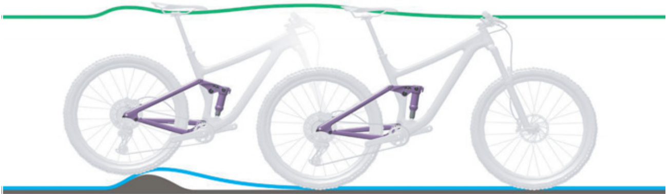
103. ábra: A hátsó lengéscsillapító túl kemény csillapítása egyenetlenségeknél
