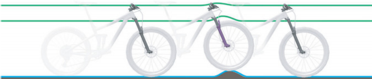
76. ábra: Optimális menetviselkedés egyenetlenségek esetén
