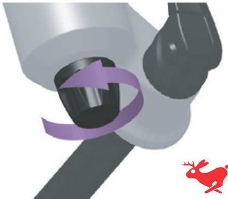
92. ábra: A húzófokozatos lengéscsillapító fordítása a nyúl irányába
