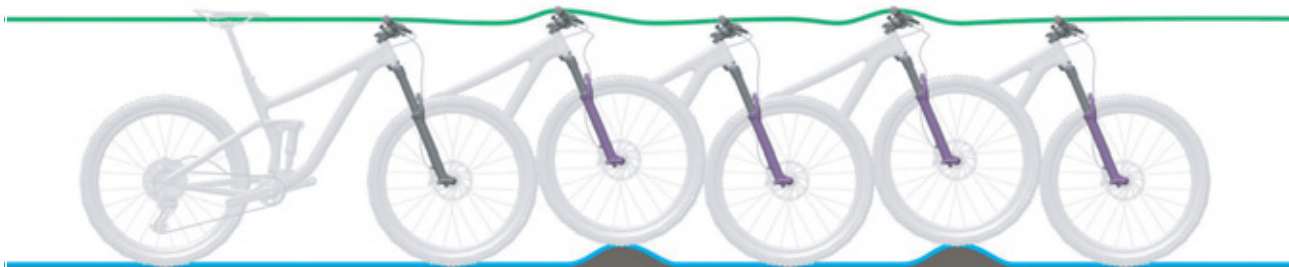
5. ábra: A villa optimális menetviselkedése
