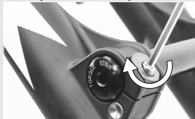
27. ábra: A rögzítőkapocs meghúzása
