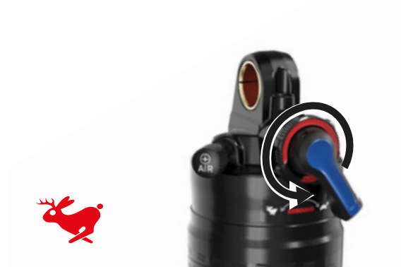
67. ábra: A kirugózási sebesség növelése
