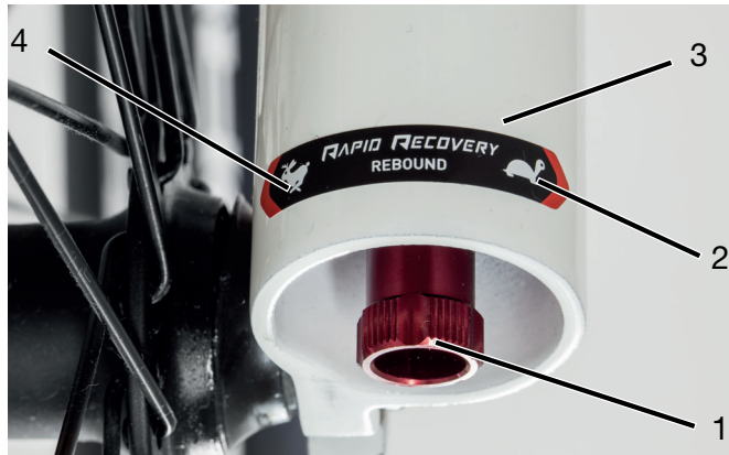
Illustration 20 : Régler l'amortisseur de détente, exemple avec symboles de lièvre et tortue
