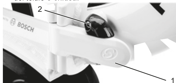
Figura 84: Telaio con leva di serraggio (1) chiusa e leva di sicurezza (2) chiusa
