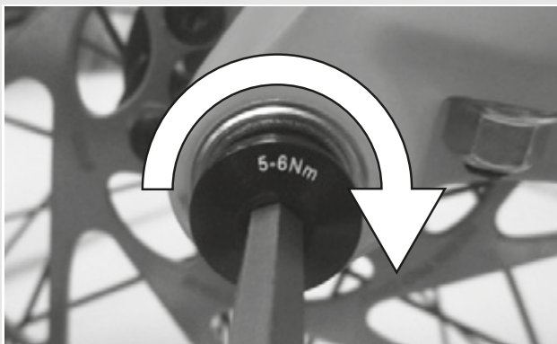
Figura 35: Serraggio della vite di sicurezza
