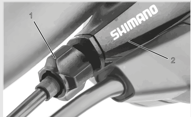
Figura 90: Boccola di regolazione (1) del cambio azionato da cavo singolo con scatola della leva del cambio (2), esempio
