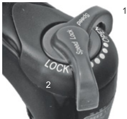
Figura 76: Regolatore dello stadio di pressione Suntour con posizioni OPEN (1) e LOCK (2)
