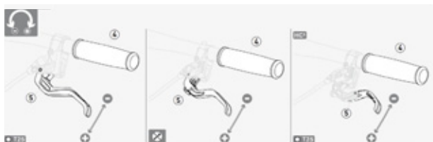
Figura 62: Regolazione dell'ampiezza di presa della leva del freno Magura con freno a disco
