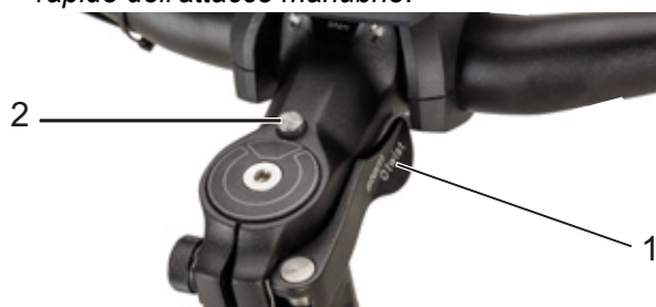
Figura 82: Attacco manubrio, versione II con leva di serraggio (1) del bloccaggio rapido dell'attacco manubrio e bottone di sbloccaggio (2)
