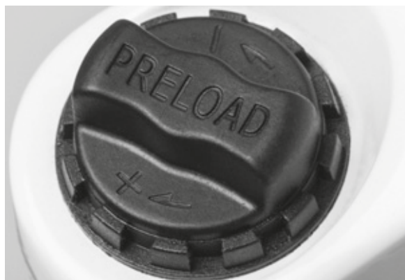
Figura 64: Manopola di regolazione dell'escursione negativa della sospensione sulla corona della forcella ammortizzata
