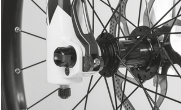
Figura 88: Regolazione della forza di serraggio del bloccaggio rapido
