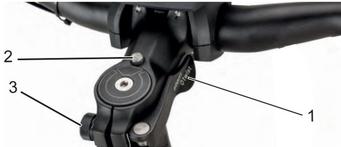
Abbildung 19: Vorbau, Ausführung II mit Spannhebel (1), Entsperrknopf (2) und Rändelmutter (3)
