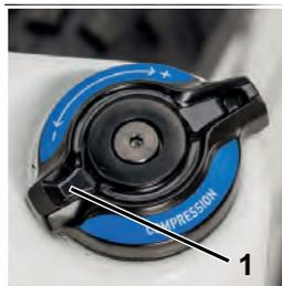
► Um die Federung zu sperren, Sperrhebel in Plus-Richtung drehen.
