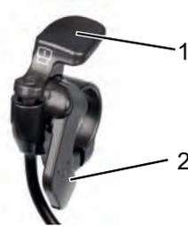
► Um die *Federung des Vorderrads* zu entsperren, den seitlichen Entsperrhebel drücken.
