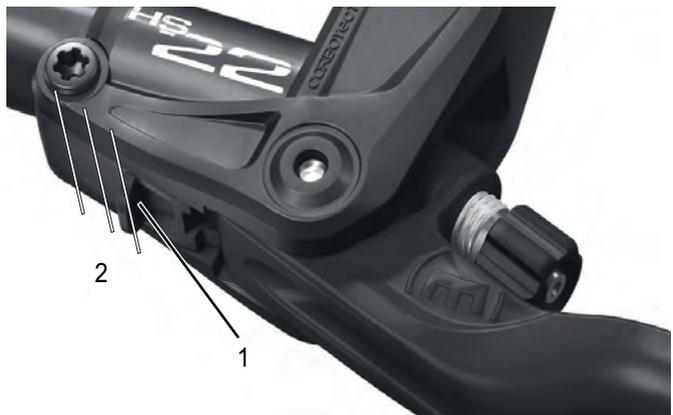
Abbildung 27: Bremshebel mit Schieber (1) und seinen drei Positionen (2)
