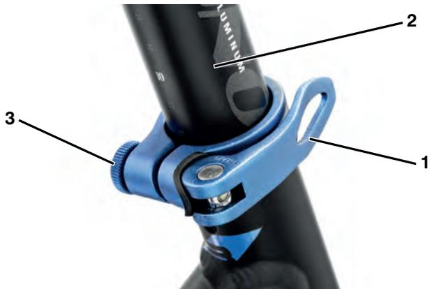
Abbildung 16: Schnellspanner der Sattelstütze in der Endposition
