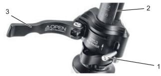
Illustration 61 : Levier de serrage ouvert de l'attache rapide de la potence (3) sur la potence (2), modèle I, avec levier de blocage sur la potence (1)
