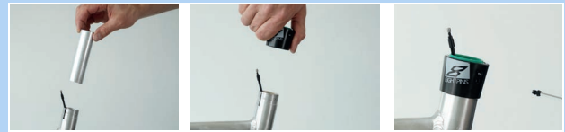
Abbildung 184: Gleitbuchse und Außenhülse einbauen
