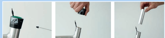
Abbildung 202: Außenhülse und Gleitbuchse ausbauen
