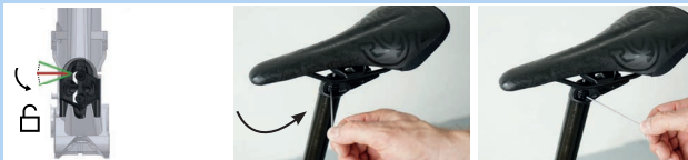
Abbildung 160: Höhenverstellungsbetätigung in „Geöffnete Stellung“ bringen
