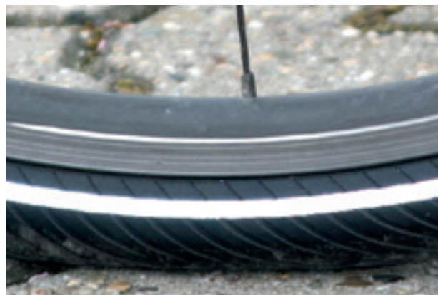
Abbildung 97: Korrekter Fülldruck. Der Reifen ist unter der Last des Körpergewichts kaum verformt.
