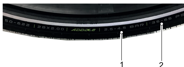
Abbildung 147: Fülldruck in bar (1) und psi (2)
