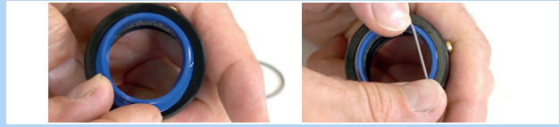
Abbildung 209: Abstreifer einlegen und befestigen
