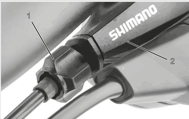
Figura 85: Boccola di regolazione (1) del cambio azionato da cavo singolo con scatola della leva del cambio (2), esempio
