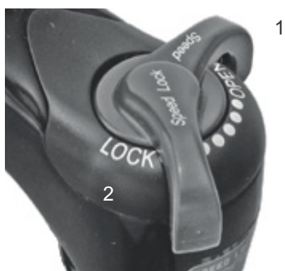
Figura 75: Regolatore della compressione Suntour con posizioni OPEN (1) e LOCK (2)
