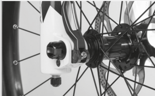
Figura 36: Corretta posizione della leva di serraggio
