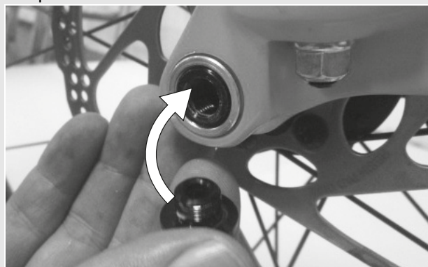
Figura 28: Applicazione della leva del bloccaggio rapido nel perno
