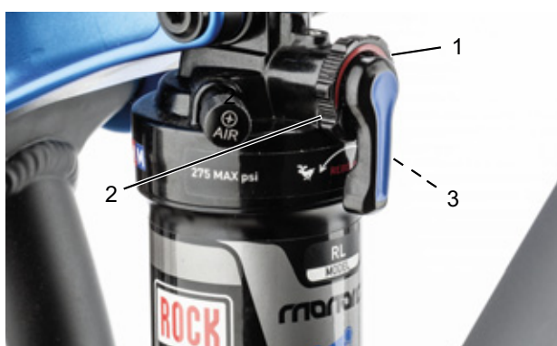
Figura 78: Regolazione della rigidità dell'ammortizzatore a stadi di trazione con la manopola di regolazione (1) dell'ammortizzatore del carro posteriore
