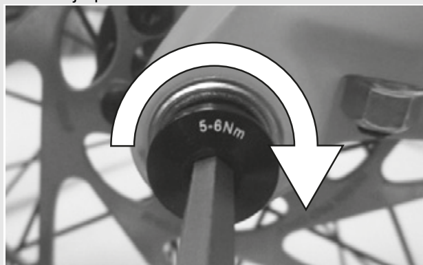
Obr. 23: Utažení pojistného šroubu
