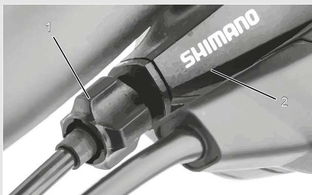
Obr. 74: Seřizovací pouzdro (1) řazení převodů ovládané jedním lankem s řadicí páčkou (2) - příklad
