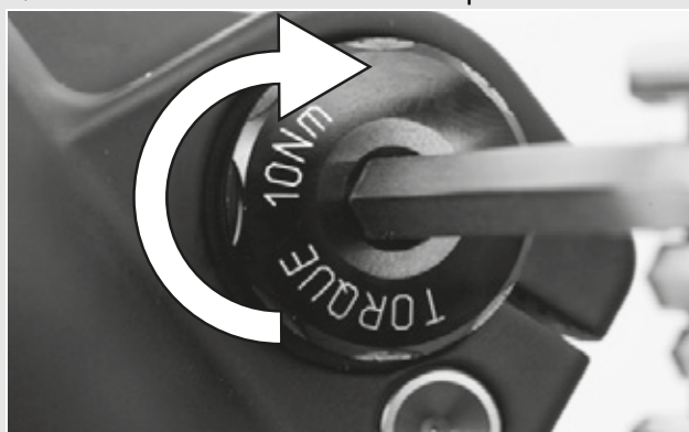
Obr. 24: Utažení zasunuté osy
