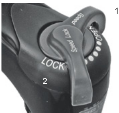
Obr. 64: Nastavovací šroub komprese Suntour s polohami OTEVŘENÁ (1) a UZAVŘENÁ (2)
