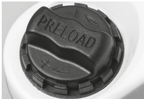
Obr. 52: Nastavovací kolečko zanoření na korunce odpružené vidlice
