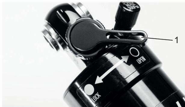
Abbildung 76: Suntour-Druckstufeneinsteller geöffnet (1)
