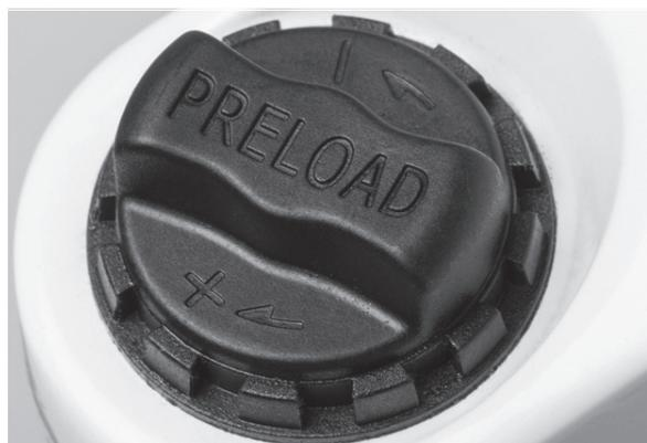
Abbildung 56: Einstellrad des Negativfederwegs auf der Krone der Federgabel
