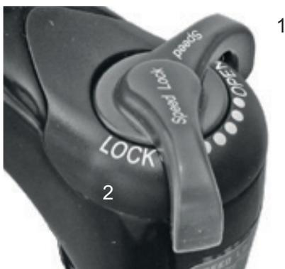
Abbildung 75: Suntour-Druckstufeneinsteller mit den Positionen OPEN (1) und LOCK (2)
