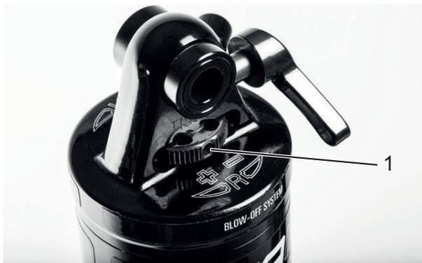
Abbildung 60: Suntour-Zugstufeneinsteller Rad (1) am Hinterbau-Dämpfer
