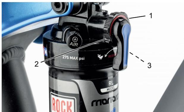
Abbildung 78: Härte des Zugstufen-Dämpfers am Einstellrad (1) des Hinterbau-Dämpfers einstellen
