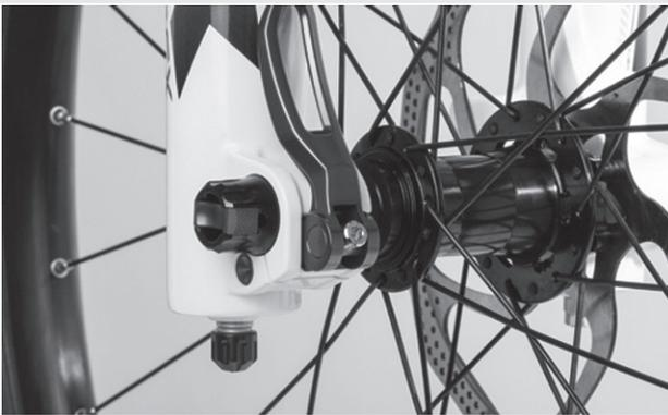
Abbildung 36: Perfekte Lage des Spannhebels
