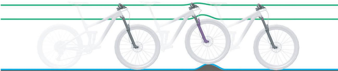
Abbildung 55: Optimales Fahrverhalten bei Unebenheiten
