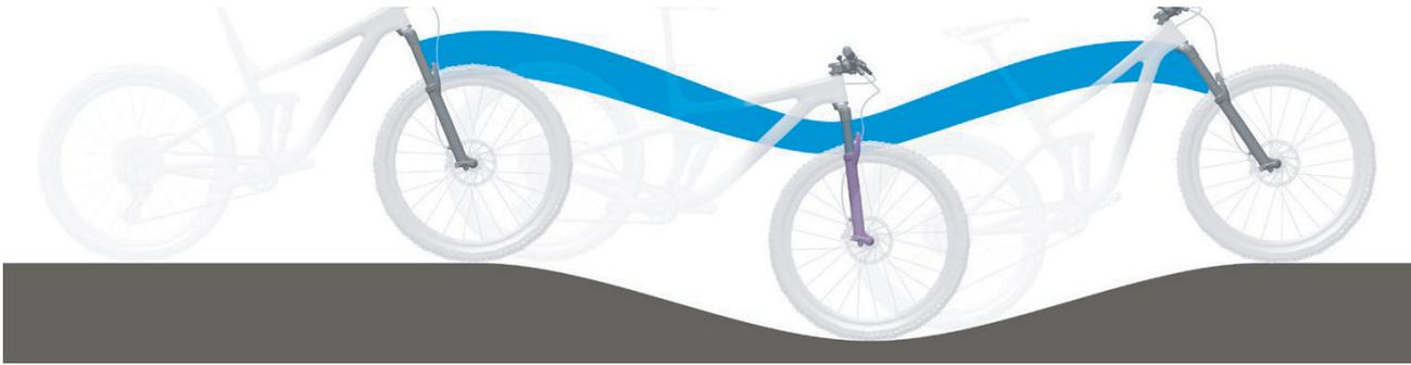
**Abbildung 5: Optimales Fahrverhalten der Gabel im hügeligen Gelände**
