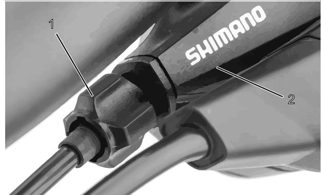
Abbildung 64: Einstellhülse (1) der einzügigen, seilzugbetätigten Gangschaltung mit Schalthebelgehäuse (2), Beispiel
