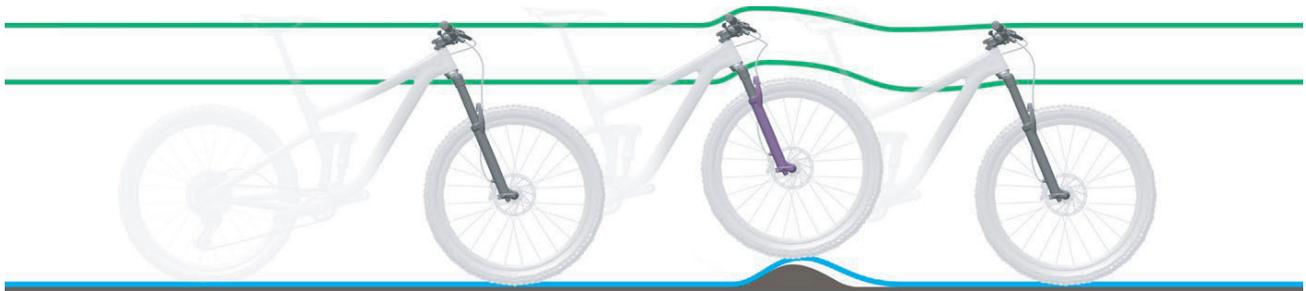
Abbildung 73: Zu harte Dämpfung der Federgabel bei Unebenheiten
