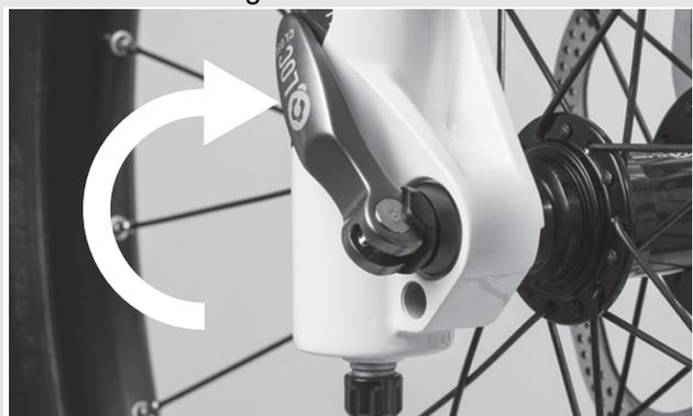
Abbildung 29: Schnellspanner schließen
