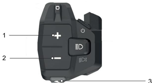
Abbildung 47: Lage Plus- (1), Minus (2), und Schiebehilfe-(3) Taster
