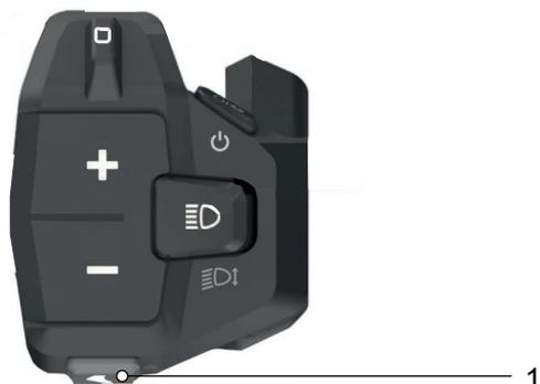
Abbildung 45: Lage Schiebehilfe-Taster
