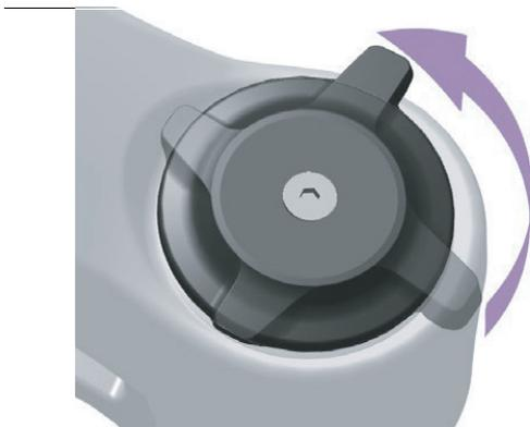
Abbildung 74: Druckstufeneinsteller weicher einstellen
