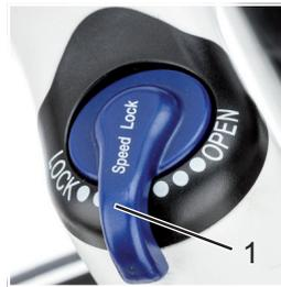
► Um die *Federung des Vorderrads* zu sperren, *Sperrhebel* in die Position LOCK schieben.
