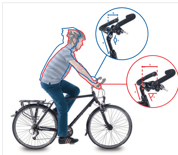
Abbildung 136: Citybike (blau) und Trekkingrad Position (rot) durch Winkeländerung
