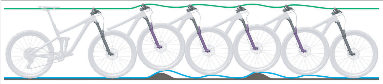
Abbildung 247: Zu schnelles Ausfedern der Federgabel
