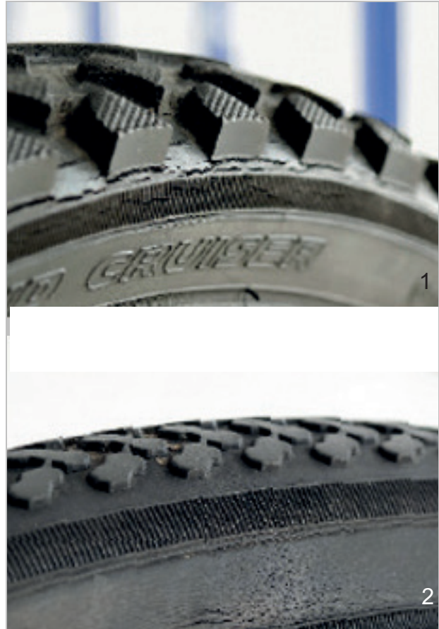
Abbildung 213: Beispiele für Ermüdungsrisse (1) und Alterungsrisse (2)
