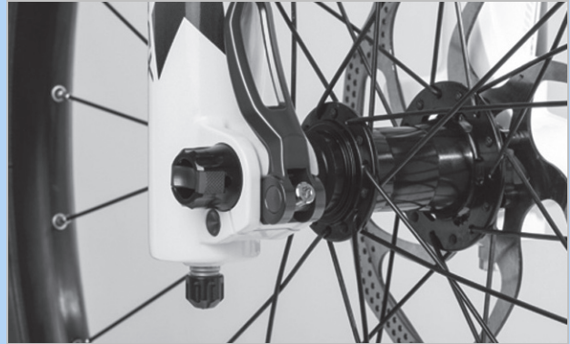
Abbildung 242: Spannkraft des Schnellspanners einstellen
