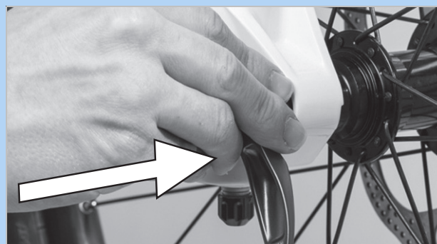
Abbildung 109: Schnellspanner in Pfeilrichtung einschieben
