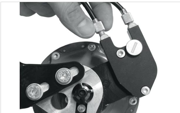
Abbildung 239: ROHLOFF-Naben Versionen mit externer Schaltansteuerung haben die Zugeinsteller an der Seilbox, die sich auf der linken Seite befindet
