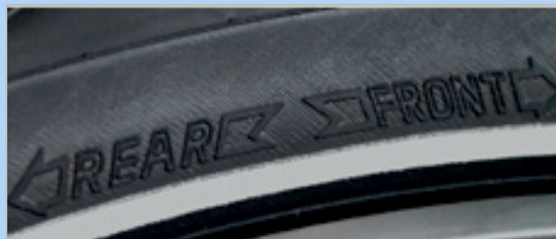
Abbildung 97: Laufrichtungspfeil auf MTB-Reifen
