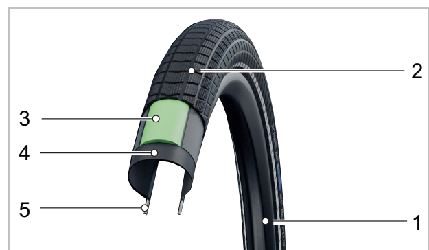
Abbildung 31: Aufbau offener Reifen
