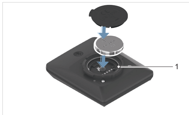
Abbildung 162: Batterie einlegen mit korrekt ausgerichtetem Dichtgummi (1)
