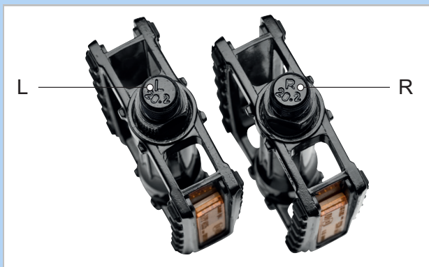
Abbildung 112: Beispiel Markierung von Pedalen
