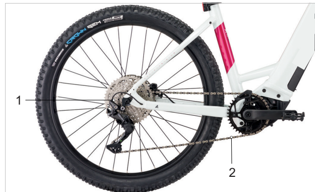
Abbildung 54: Schema Kettenantrieb mit Kettenschaltung
