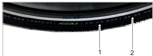
Abbildung 211: Angabe Fülldruck in bar (1) und psi (2)
