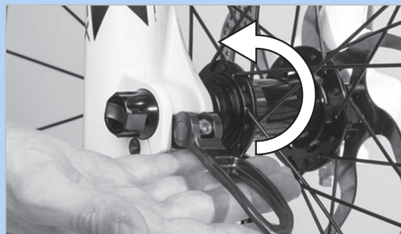
Abbildung 105: Schnellspannhebel in Pfeilrichtung drücken
