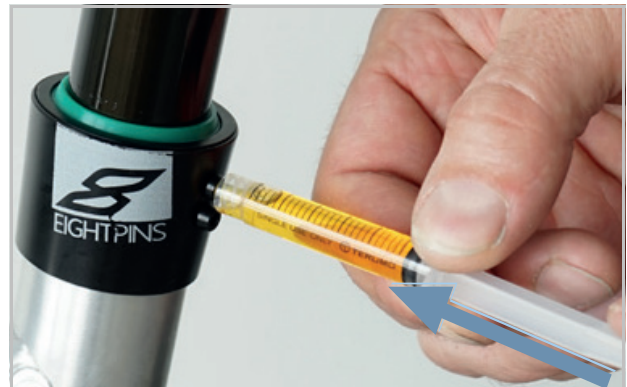
Abbildung 210: EIGHTPINNS Sattelstütze schmieren
