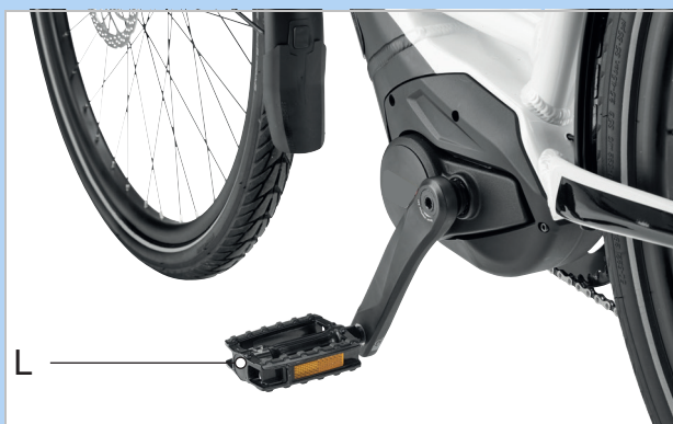
Abbildung 113: L-Pedal im linken Kurbelarm
