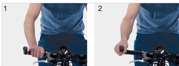
Abbildung 183: Griffpositionen am Bar End
