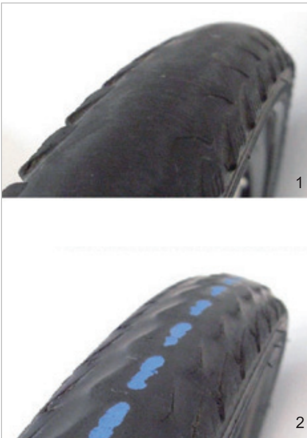
Abbildung 212: Reifen ohne Profil, der gewechselt werden kann (1) und Reifen mit durchscheinendem Pannenschutz (2), der gewechselt werden muss
