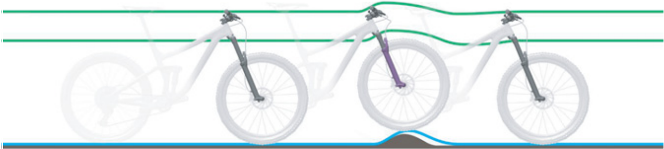
Afbeelding 223: Te harde demping de verende voorvork bij oneffenheden
