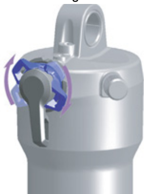
Afbeelding 108: Drukdemperafsteller harder afstellen
