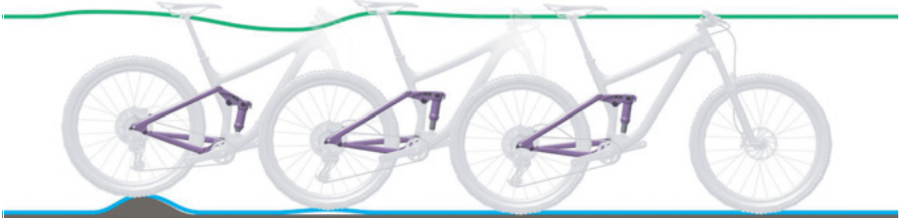
Afbeelding 225: Te snel uitveren van de achterbouwdeemper
