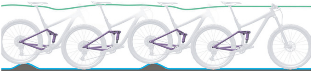
Afbeelding 18: Optimaal rijgedrag van de achterbouwdemper
