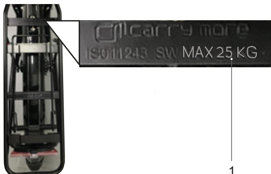
Afbeelding 117: Op de bagagedrager staat het maximale draagvermogen (1) vermeld
