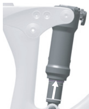
Afbeelding 100: O-ring op de achterbouwdemper verschuiven
