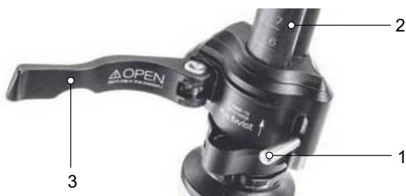
Afbeelding 50: Geopende spanhendel van de snelspanner (3) op de voorbouw (2), uitvoering I, met vergrendelhendel op de voorbouw (1)
