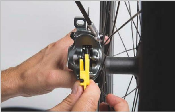
Illustration 104 : Contrôler la plaquette de frein montée à l'aide de la cale de transport
