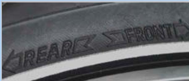
Illustration 41 : Flèche directionnelle sur les pneus VTT
