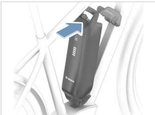
110. ábra: PowerPack akkumulátor felfelé hajtása
