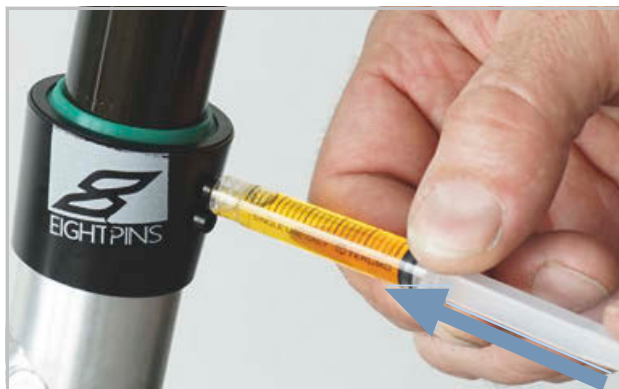
136. ábra: EIGHTPINS nyeregcső kenése
