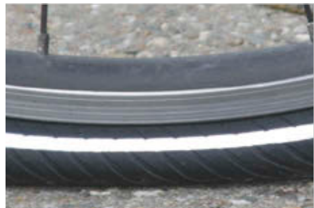
88. ábra: Túlontúl alacsony töltőnyomás
