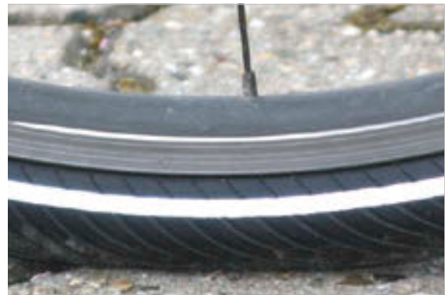
87. ábra: Helyes töltőnyomás. A gumiabroncs alakja a testsúly terhe alatt alig változik
