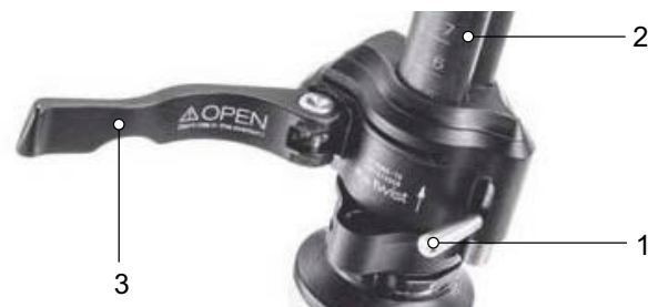
Afbeelding 201: Geopende spanhendel van de snelspanner (3) op de voorbouw (2), uitvoering I, met vergrendelhendel op de voorbouw (1)
