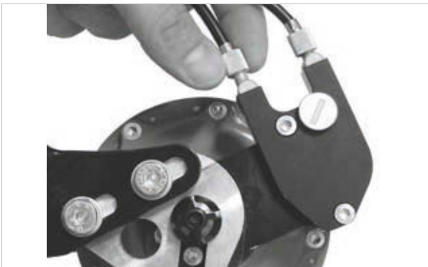
Afbeelding 239: Bij ROHLOFF naafversies met externe schakelaansturing zit de kabelafsteller op de kabelbox aan de linkerkzijde
