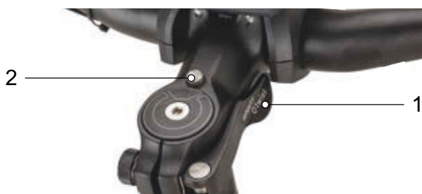
Afbeelding 202: Voorbouw, uitvoering II met spanhendel van de snelspanner van de voorbouw (1) en deblokkeringsknop (2)
