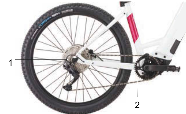
Afbeelding 54: Schema kettingaandrijving met derailleur
