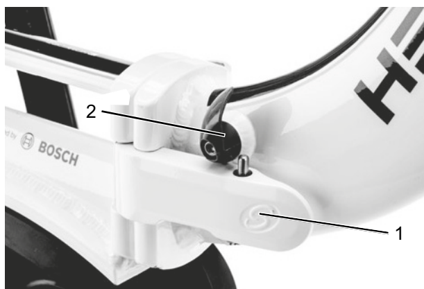
Afbeelding 203: Gesloten (1) en geopende (2) framevergrendelhendel
