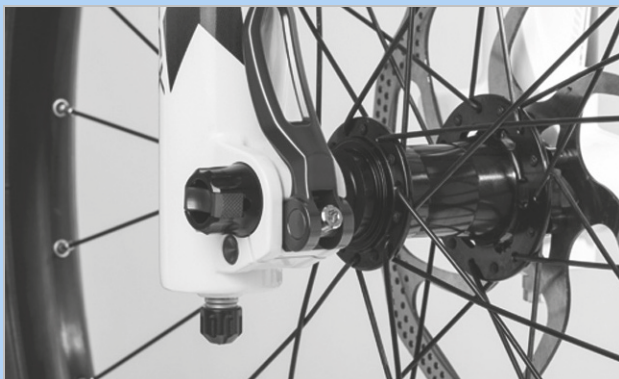
Afbeelding 242: Spankracht van de snelspanner afstellen
