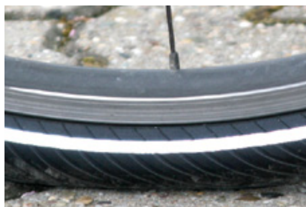
Illustration 122 : Pression correcte. Le pneu se déforme à peine sous le poids du corps.
