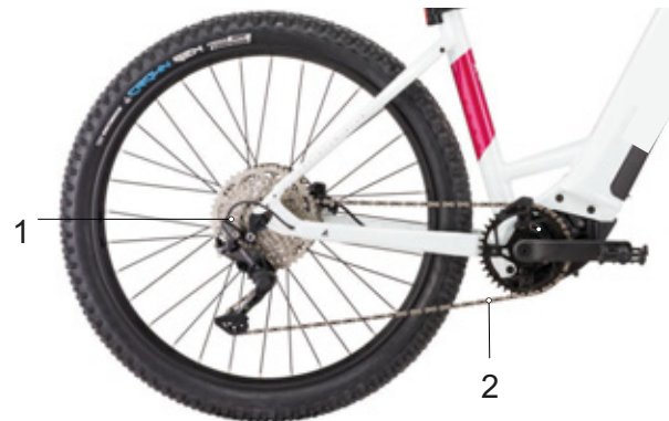
Illustration 37 : Schéma de l'entraînement à chaîne avec dérailleur
