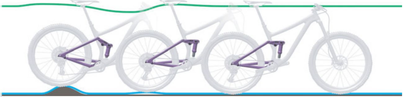
Illustration 227 : Détente trop rapide de l'amortisseur arrière
