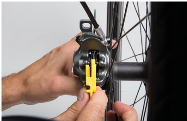
Illustration 170 : Contrôler la plaquette de frein montée à l'aide de la cale de transport
