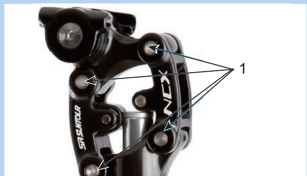
Illustration 201 : Points de lubrification de la tige de selle suspendue SR SUNTOUR
