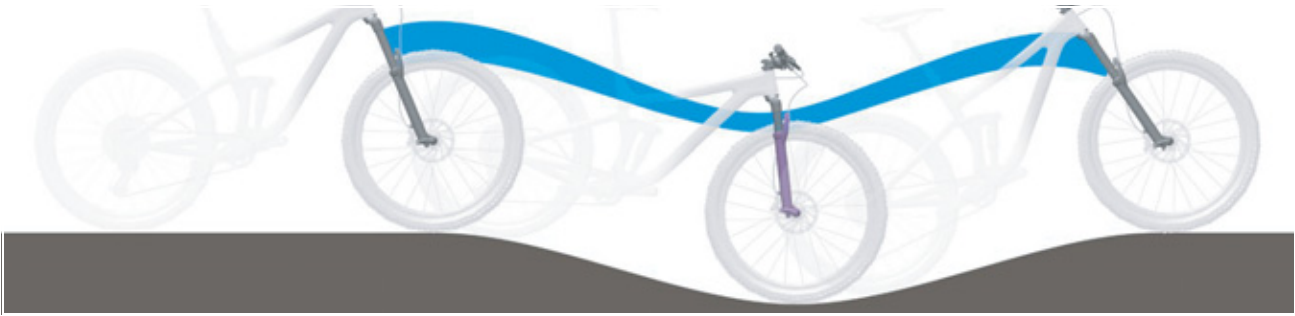
Illustration 215 : Suspension trop souple de la fourche suspendue dans les côtes
