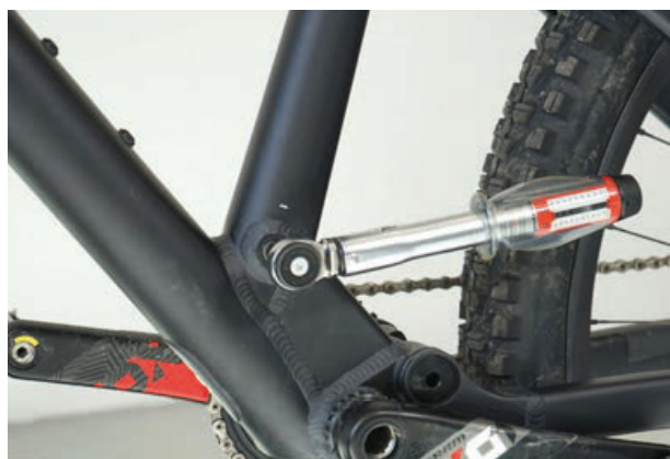
Illustration 106 : Serrer l'axe de la tige de selle
