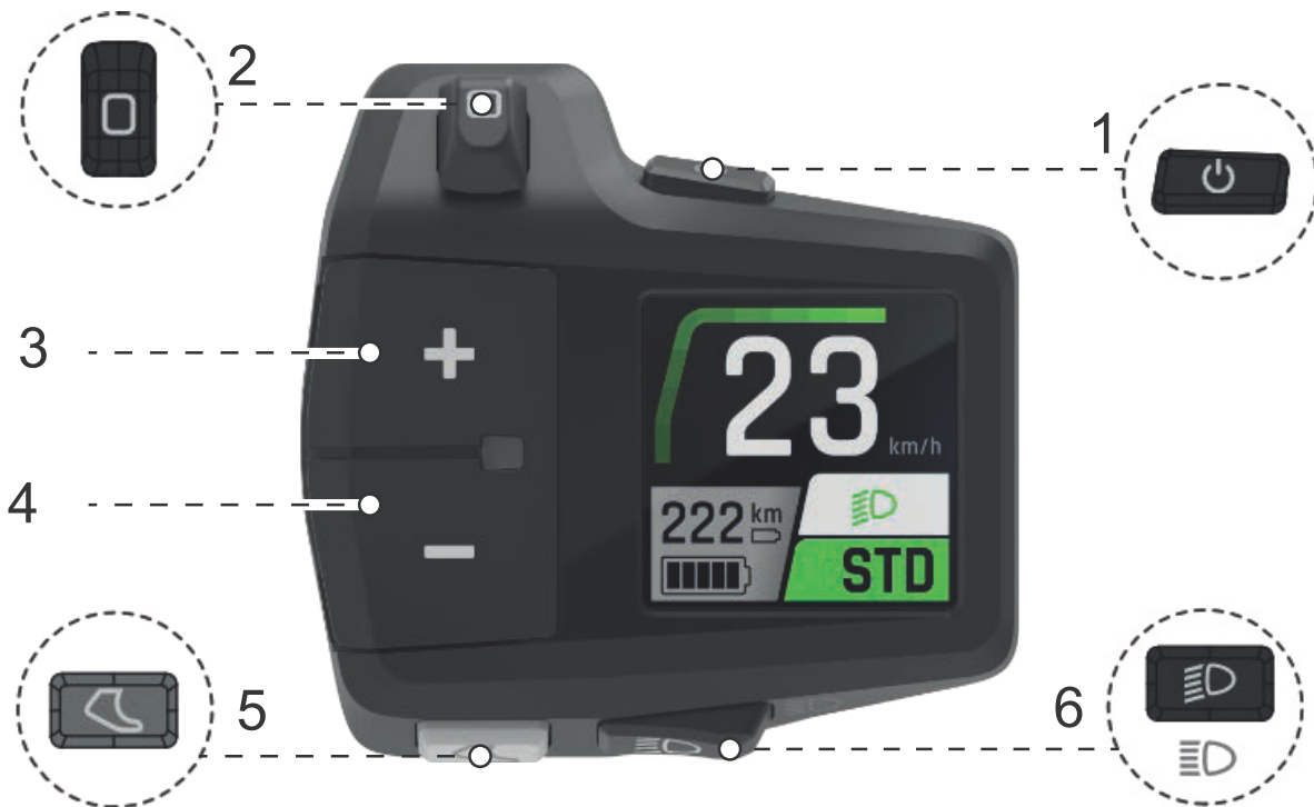
Illustration 43 : Vue d'ensemble de l'unité de commande
