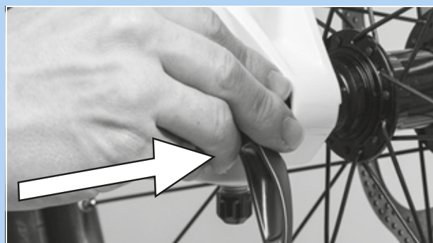
Illustration 82 : Enfoncez l'attache rapide dans le sens de la flèche
