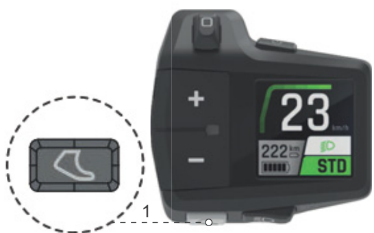
Illustration 152 : Position de la touche d'assistance de poussée
