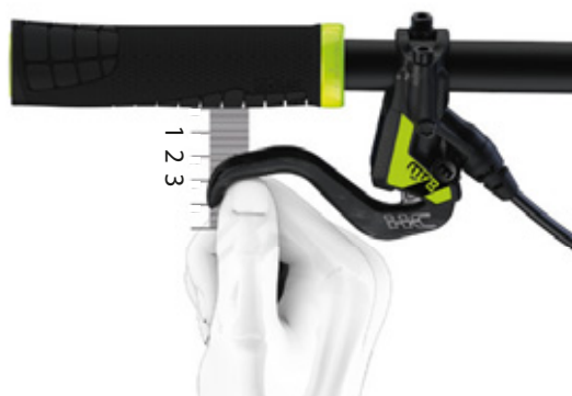
Illustration 127 : Positionnement du frein à main
