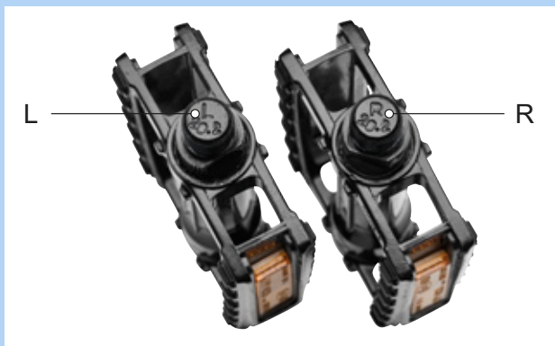
Illustration 90 : Exemple de marquage de pédales
