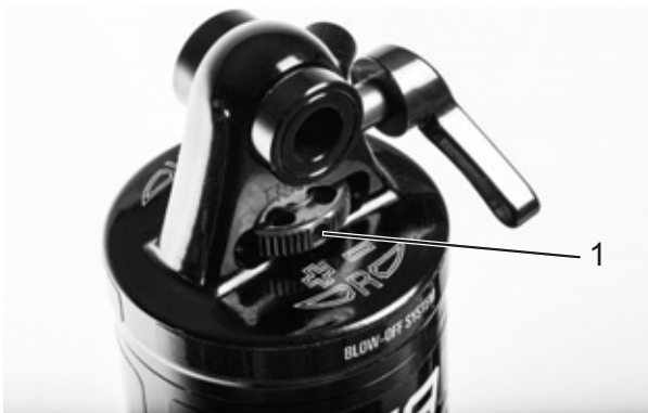
Illustration 222 : Molette de réglage de la détente SR SUNTOUR (1) sur l'amortisseur arrière
