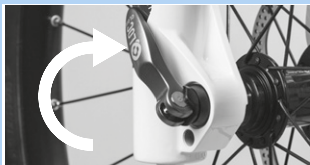
Illustration 84 : Fermer l'attache rapide
