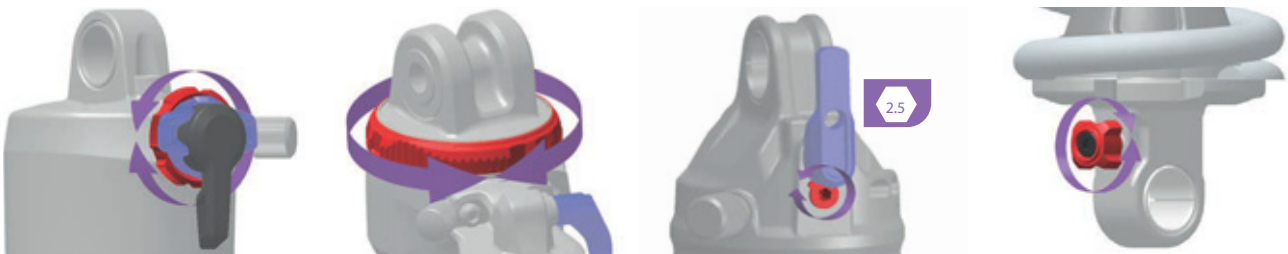
Illustration 230 : La position et la forme du dispositif de réglage de la détente (rouge) dépendent du modèle
