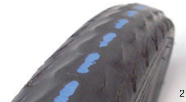
Illustration 168 : Pneu sans profil pouvant être changé (1) et pneu avec protection anti-crevaison visible (2) devant être changé
