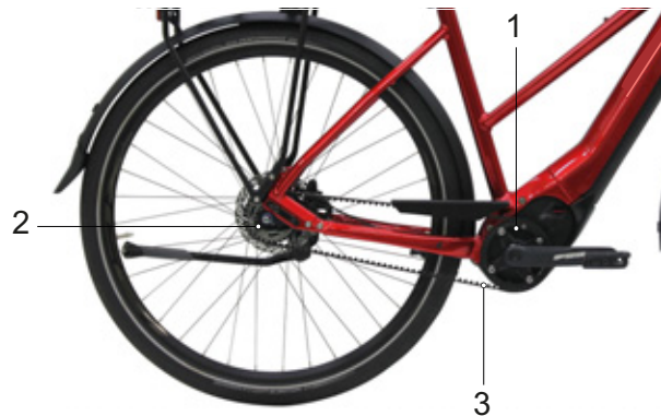
Illustration 38 : Schéma de l'entraînement à courroie
