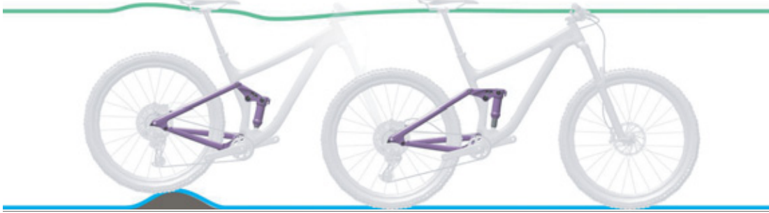
Illustration 18 : Comportement optimal de l'amortisseur arrière sur des irrégularités
