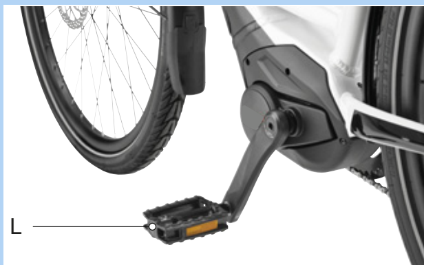
Illustration 91 : Pédale L dans le bras de manivelle gauche
