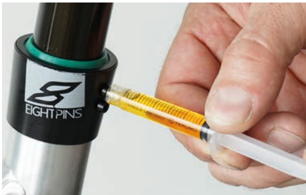
Illustration 166 : Lubrifier une tige de selle eightpins
