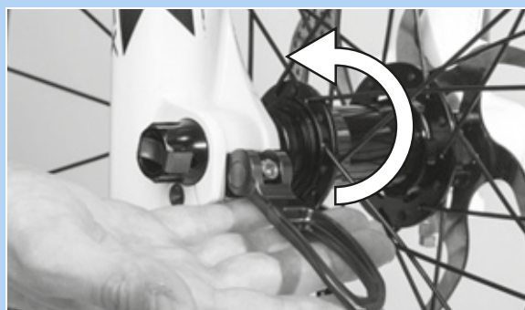
Illustration 78 : Enfoncez le levier d'attache rapide dans le sens de la flèche
