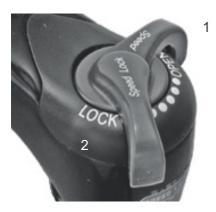
Figura 78: Regolatore della compressione Suntour con posizioni OPEN (1) e LOCK (2)
