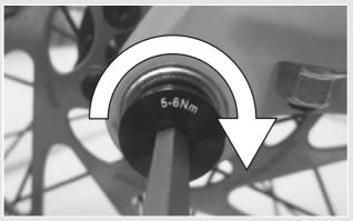
Figura 27: Serraggio della vite di sicurezza
