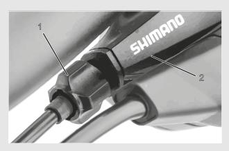
Figura 84: Boccola di regolazione (1) del cambio azionato da cavo singolo con scatola della leva del cambio (2), esempio
