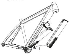
Figura 70: Montaggio dell'unità di trazione nel pedelec
