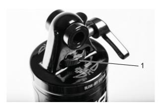
Figura 60: Regolatore del rebound Suntour (1) sull'ammortizzatore del carro posteriore
