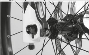
Figura 82: Regolazione della forza di serraggio del bloccaggio rapido
