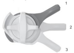
Figura 76: Regolatore della compressione FOX sull'ammortizzatore del carro posteriore con le posizioni APERTO (1), MEDIO (2) e RIGIDO (3)
