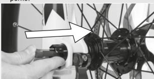
Figura 32: Applicazione della leva del bloccaggio rapido nel perno
