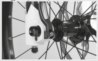
Figura 34: Corretta posizione della leva di serraggio
