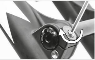
Figura 29: Serraggio del perno
