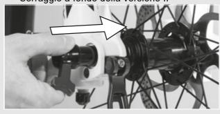
Figura 30: Applicazione del perno nel mozzo
