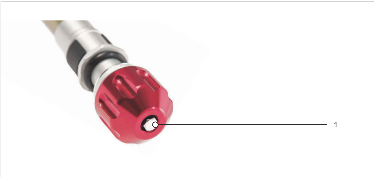
Illustration 250 : Exemple d'un réglage de détente SR SUNTOUR (fourche) (1)
