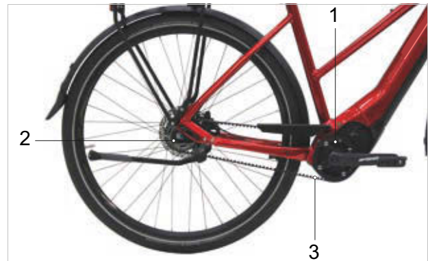
Illustration 55 : Schéma de l'entraînement à courroie
