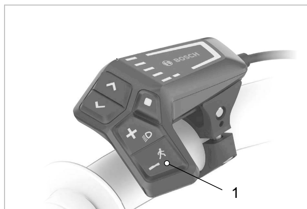
Illustration 186 : Position de la touche d'assistance de poussée (1)
