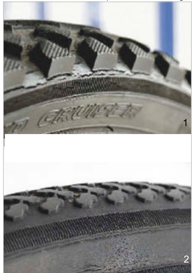
Illustration 213 : Exemples de fissures de fatigue (1) et de fissures d'âge (2)
