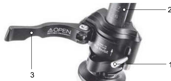
Illustration 201 : Levier de serrage ouvert de l'attache rapide de la potence (3) sur la potence (2), modèle I, avec levier de blocage sur la potence (1)
