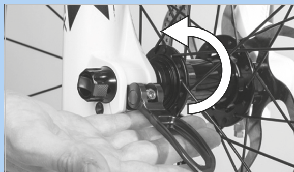
Illustration 105 : Enfoncez le levier d'attache rapide dans le sens de la flèche
