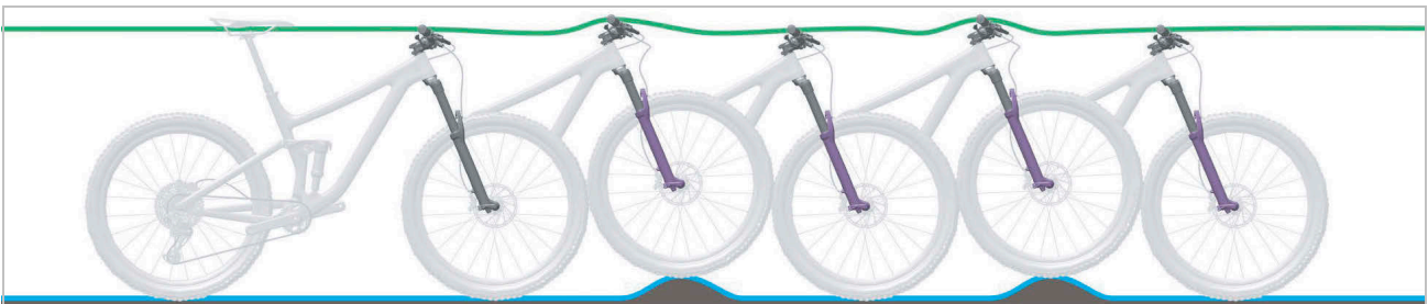
Illustration 19 : Comportement optimal de la fourche de suspension
