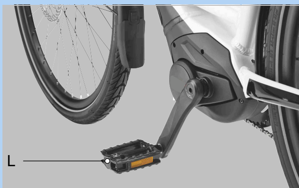
Illustration 113 : Pédale L dans le bras de manivelle gauche
