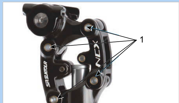
Illustration 244 : Points de lubrification de la tige de selle suspendue SR SUNTOUR
