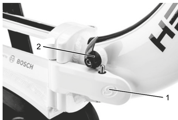
Illustration 203 : Levier de blocage du cadre fermé (1) et ouvert (2)
