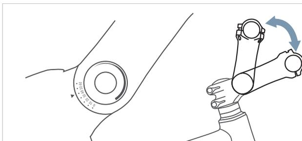
Abbildung 65: Unterschiedliche Versionen von winkelverstellbaren Vorbauten
