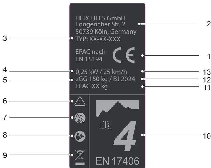
Abbildung 2: Beispiel Typenschild HERCULES
