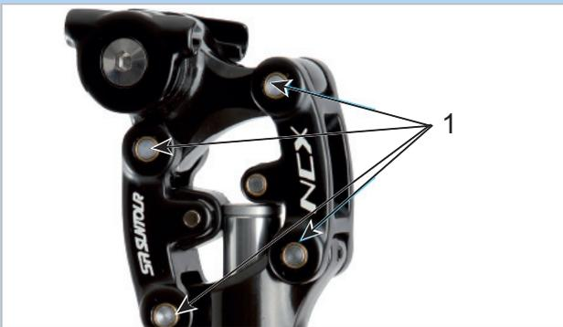
Abbildung 134: Schmierpunkte SR SUNTOUR Feder-Sattelstütze
