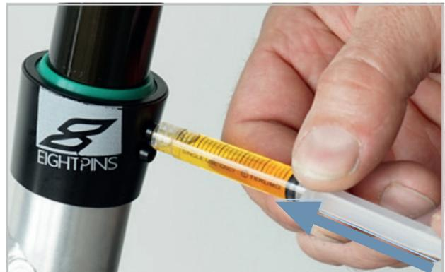
Abbildung 100: EIGHTPINNS Sattelstütze schmieren
