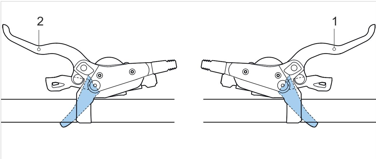
Abbildung 33: Handbremse Hinterrad (1) und Vorderrad (2), Beispiel SHIMANO Bremse
