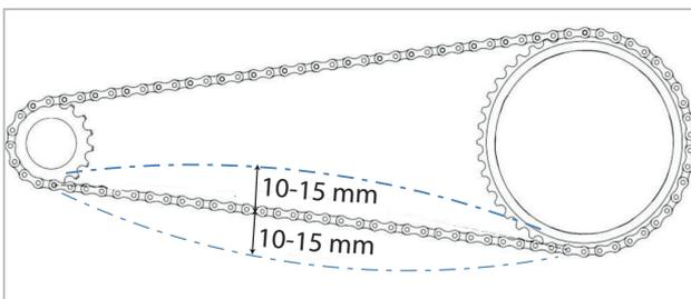
Abbildung 105: Beispiel Kettenspannung prüfen: 5 mm nach oben, 10 mm nach unten = 15 mm Abweichung
