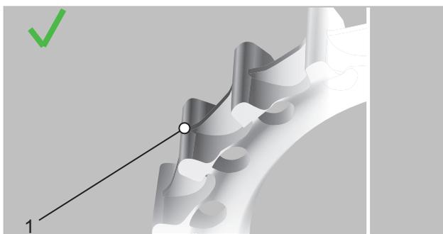
Abbildung 116: optimales Zahnprofil
