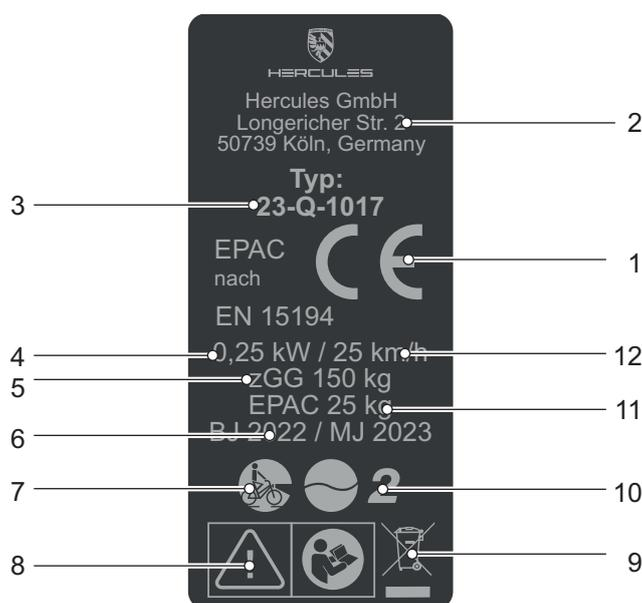
Abbildung 3: Beispiel Typenschild HERCULES
