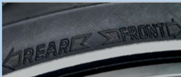
Abbildung 41: Laufrichtungspfeil auf MTB-Reifen
