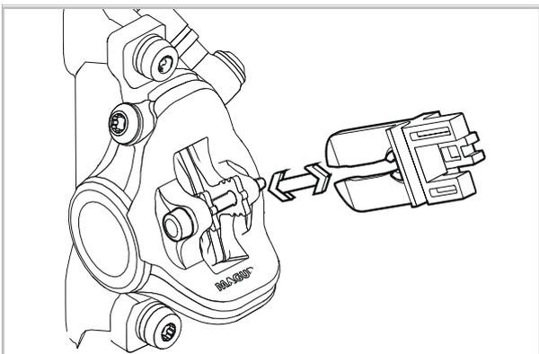
Abbildung 39: Transportsicherung befestigen
