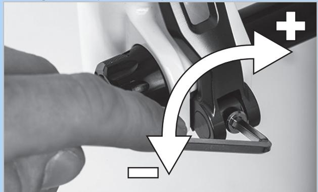
Abbildung 133: Spannkraft des Schnellspanners einstellen
