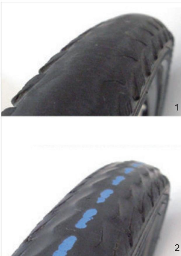
Abbildung 102: Reifen ohne Profil, der gewechselt werden kann (1) und Reifen mit durchscheinendem Pannenschutz (2), der gewechselt werden muss
