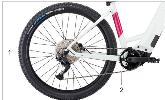
Abbildung 28: Schema Kettenantrieb mit Kettenschaltung
