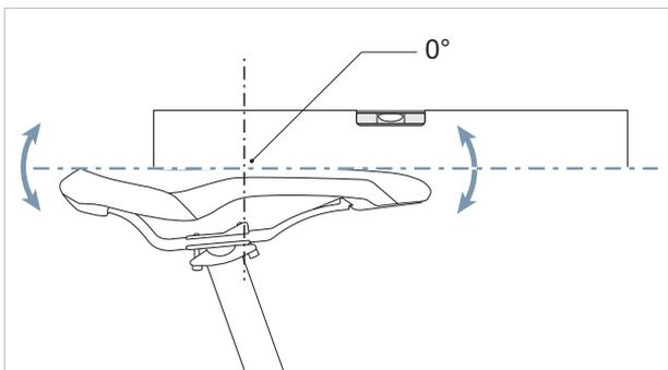
Abbildung 58: Waagerechte Sattelneigung mit 0° Neigung in der Sattelmittle
