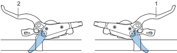
**Abbildung 92: Bremshebel Hinten (1) und vorne (2),
