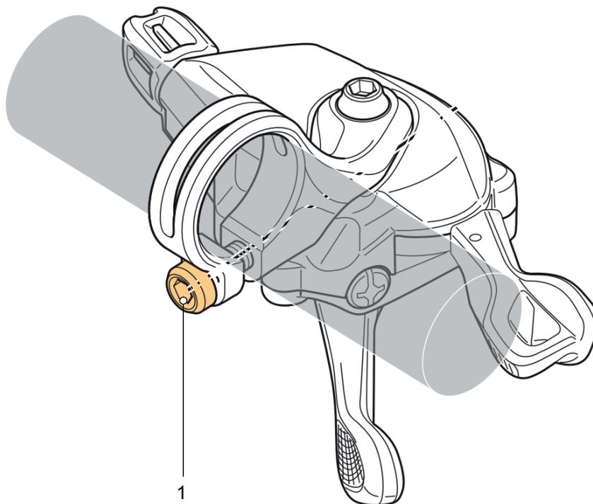
Abbildung 74: Lage Befestigungsschraube (1)
