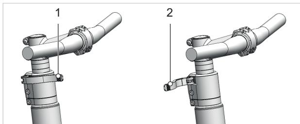
Abbildung 61: Geschlossener (1) und geöffneter (2) Vorbau-Spannhebel, Beispiel All Up
