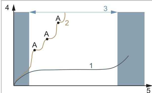
Abbildung 98: Diagramm Verschleiß, Betriebsdauer (5) zu Werkstoffabtrag (4)
