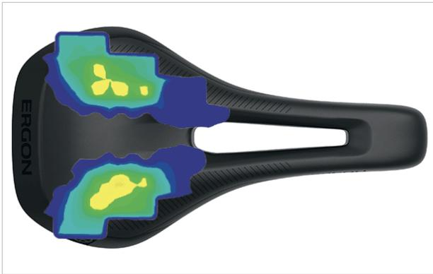
Abbildung 46: Beispiel: Damensattel der Firma ergotec
