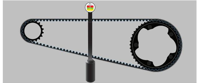
Abbildung 123: Aufgehängter Messstab
