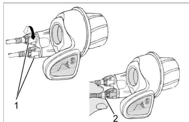
Abbildung 131: Dreh-Schaltgriff mit Einstellhülsen (1) und Drehspiel (2)
