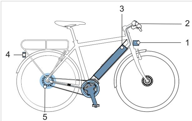
Abbildung 30: Schema elektrisches Antriebssystem mit elektrischen Bauteilen
