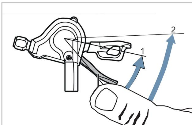
Abbildung 93: Schalten mit Hebel A, Beispiel Schaltung SL-M315
