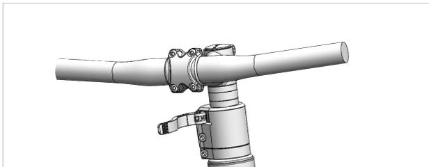
Abbildung 80: Beispiel All Up mit geöffnetem Vorbau-Spannhebel
