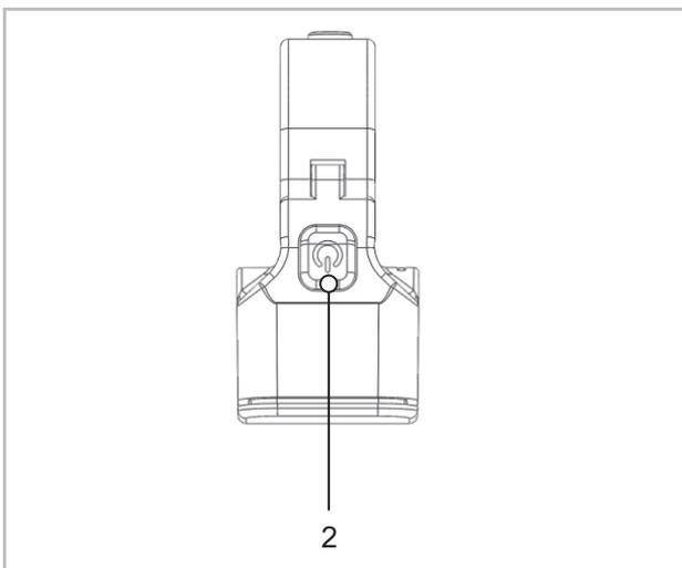
Abbildung 88: Ein-Aus-Taste auf dem Bordcomputer
