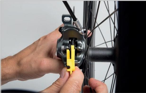
Abbildung 104: Bremsbelag im eingebauten Zustand mithilfe der Transportsicherung prüfen
