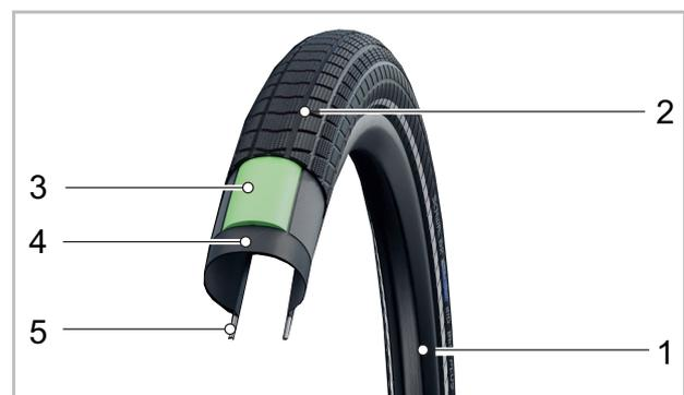
Abbildung 11: Aufbau offener Reifen
