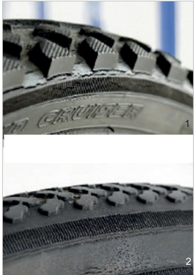
Abbildung 103: Beispiele für Ermüdungsrisse (1) und Alterungsrisse (2)
