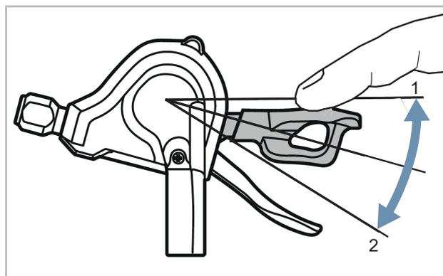
Abbildung 94: Schalten mit Hebel B, Beispiel Schaltung SL-M315
