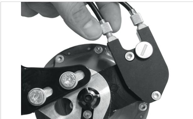
Abbildung 129: ROHLOFF-Naben Versionen mit externer Schaltansteuerung haben die Zugeinsteller an der Seilbox, die sich auf der linken Seite befindet
