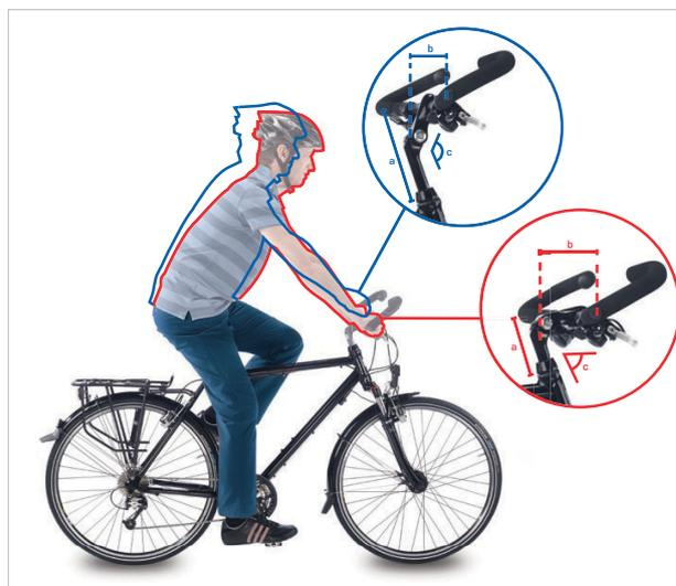
Abbildung 66: Citybike (blau) und Trekkingrad Position (rot) durch Winkeländerung
