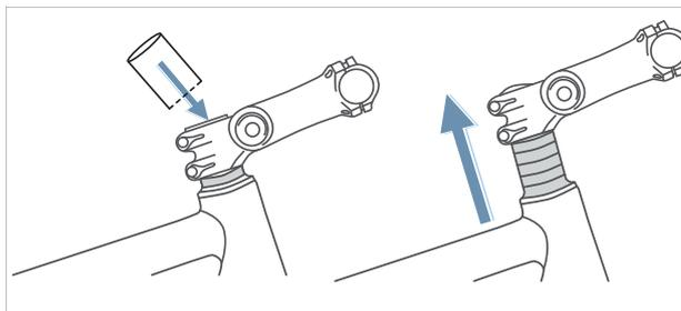
Abbildung 64: Ahead-Vorbau durch Einbau von Distanzringen (Spacer) erhöhen
