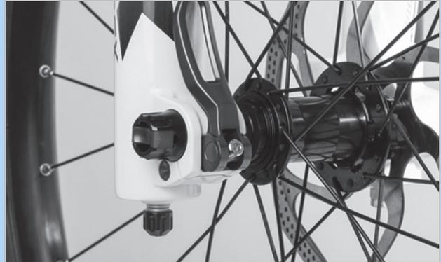
Abbildung 132: Spannkraft des Schnellspanners einstellen
