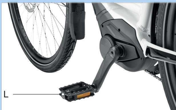
Abbildung 43: L-Pedal im linken Kurbelarm
