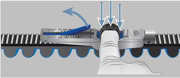
Abbildung 121: Prüflehre mit Finger herunterdrücken
