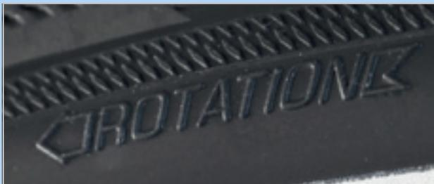
Abbildung 40: Laufrichtungspfeil
