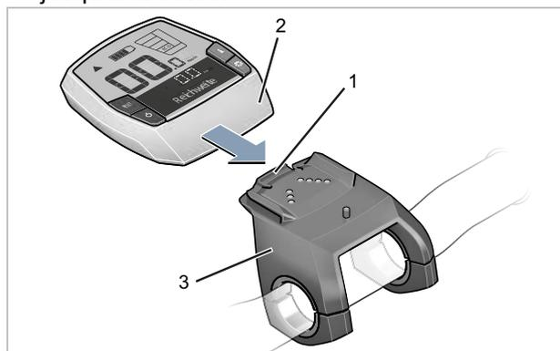
Illustration 111 : Enfoncez l'ordinateur de bord (2) via le dispositif de blocage de l'ordinateur de bord (1) jusqu'à la butée du support (3)
