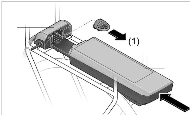
Illustration 118 : Couvrir les contacts ouverts avec un cache, exemple d'une batterie pour porte-bagages
