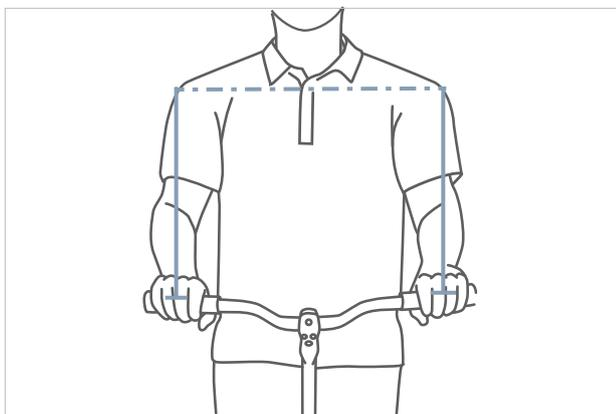
Illustration 90 : Déterminer la largeur optimale du guidon
