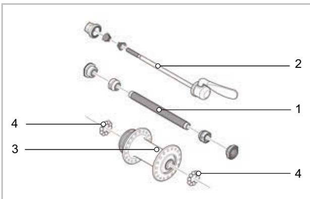
Illustration 27 : Exemple d'un moyeu de roue avant, SHIMANO
