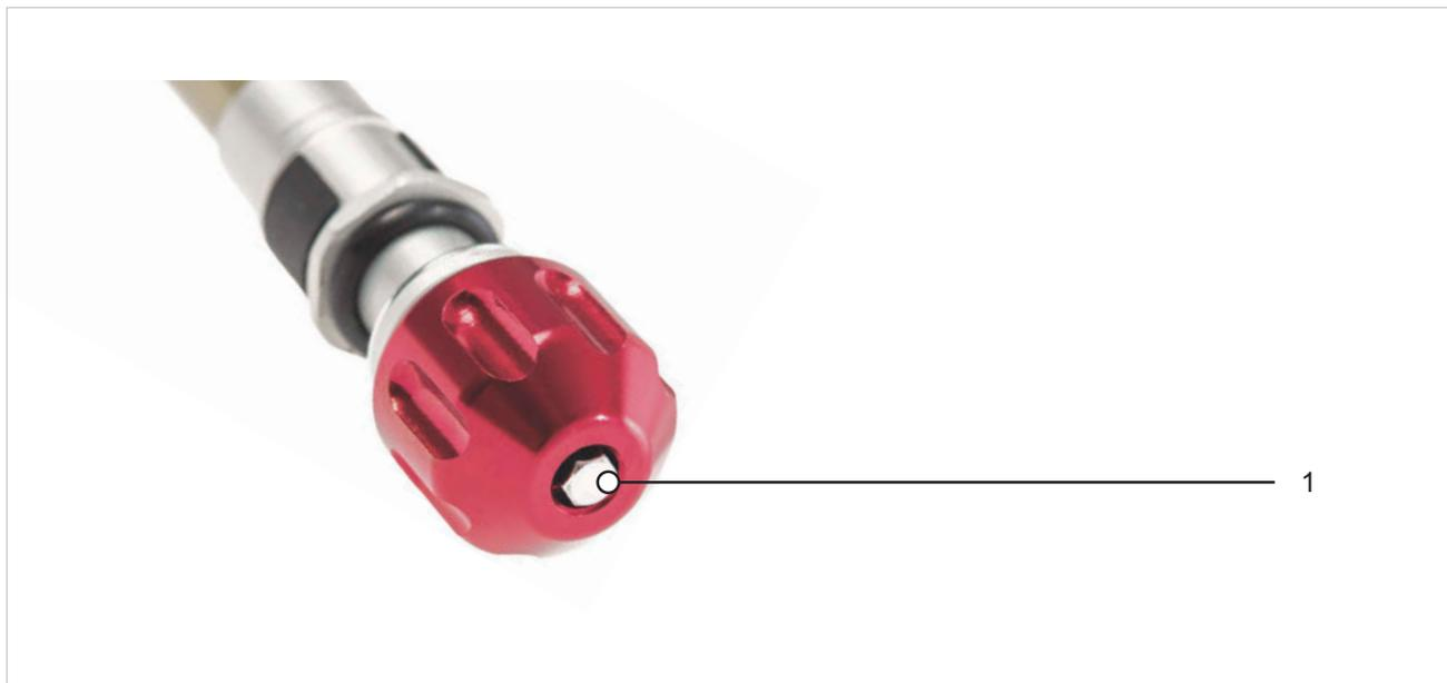
Illustration 172 : Exemple d'un réglage de détente SR SUNTOUR (fourche) (1)
