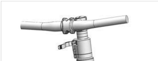
Illustration 120 : Exemple d'un All Up avec levier de serrage de la potence ouvert
