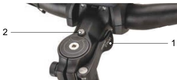
Illustration 72 : Potence, modèle II avec levier de serrage de l'attache rapide de la potence (1) et bouton de déblocage (2)
