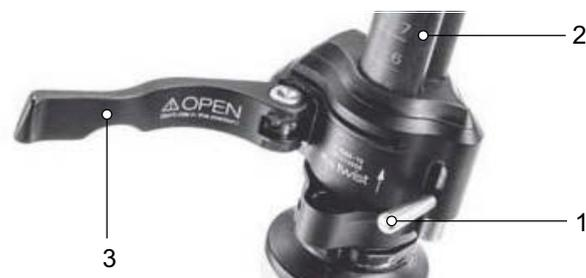
Illustration 138 : Levier de serrage ouvert de l'attache rapide de la potence (3) sur la potence (2), modèle I, avec levier de blocage sur la potence (1)
