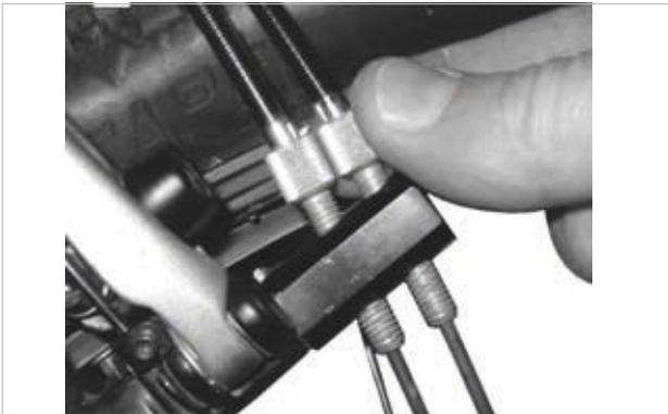
Illustration 163 : Sur les versions de moyeux ROHLOFF avec commande interne du changement de vitesse, le dispositif de réglage de la tension est situé sur le contre-support de tension
