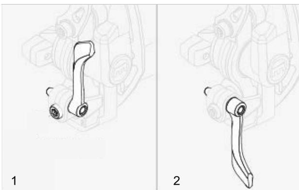
Illustration 31 : Levier de verrouillage du frein de jante, fermé (1) et ouvert (2)
