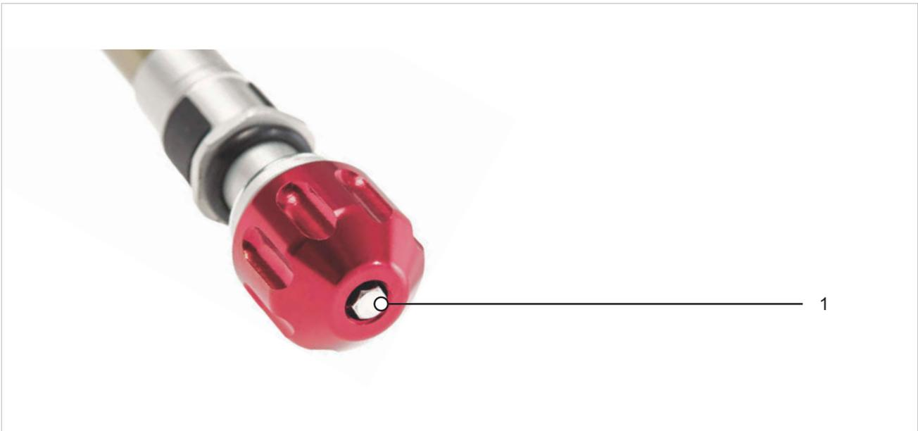
Illustration 174 : Exemple d'un réglage de détente SR SUNTOUR (fourche) (1)
