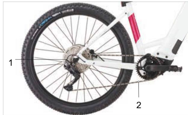
Illustration 40 : Schéma de l'entraînement à chaîne avec dérailleur
