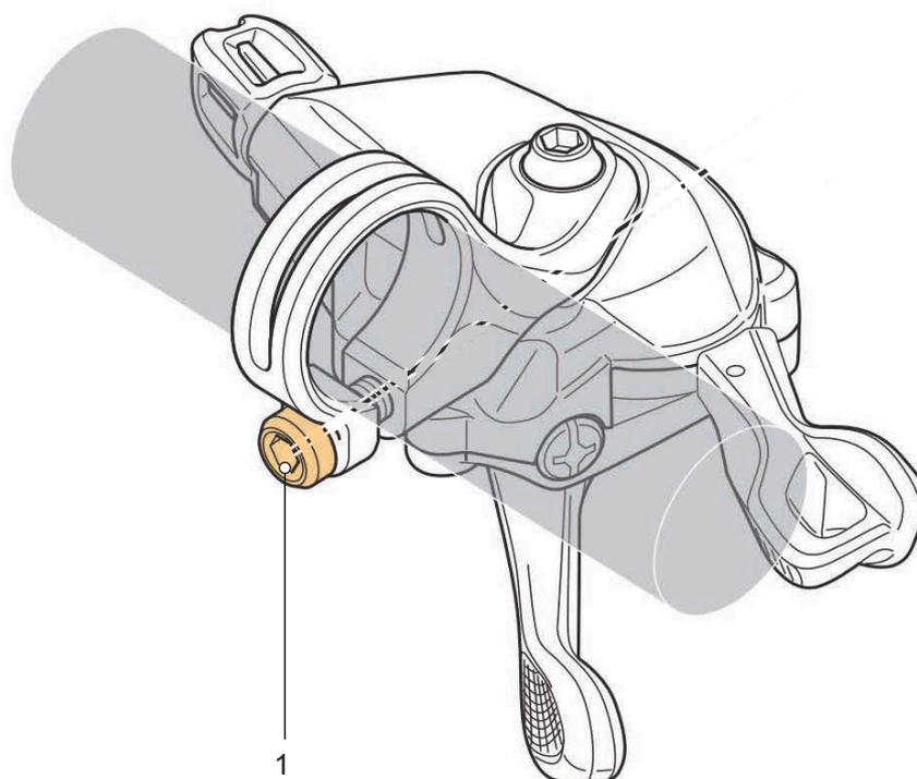
Illustration 106 : Position de la vis de fixation (1)
