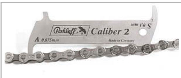
Illustration 155 : Exemple d'un gabarit de mesure ROHLOFF
