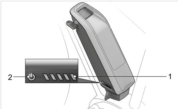
Illustration 51 : Position de l'indicateur de charge de la batterie pour tube de selle
