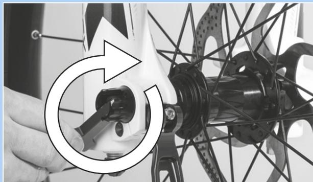
Illustration 62 : Serrer l'axe dans le sens de la flèche
