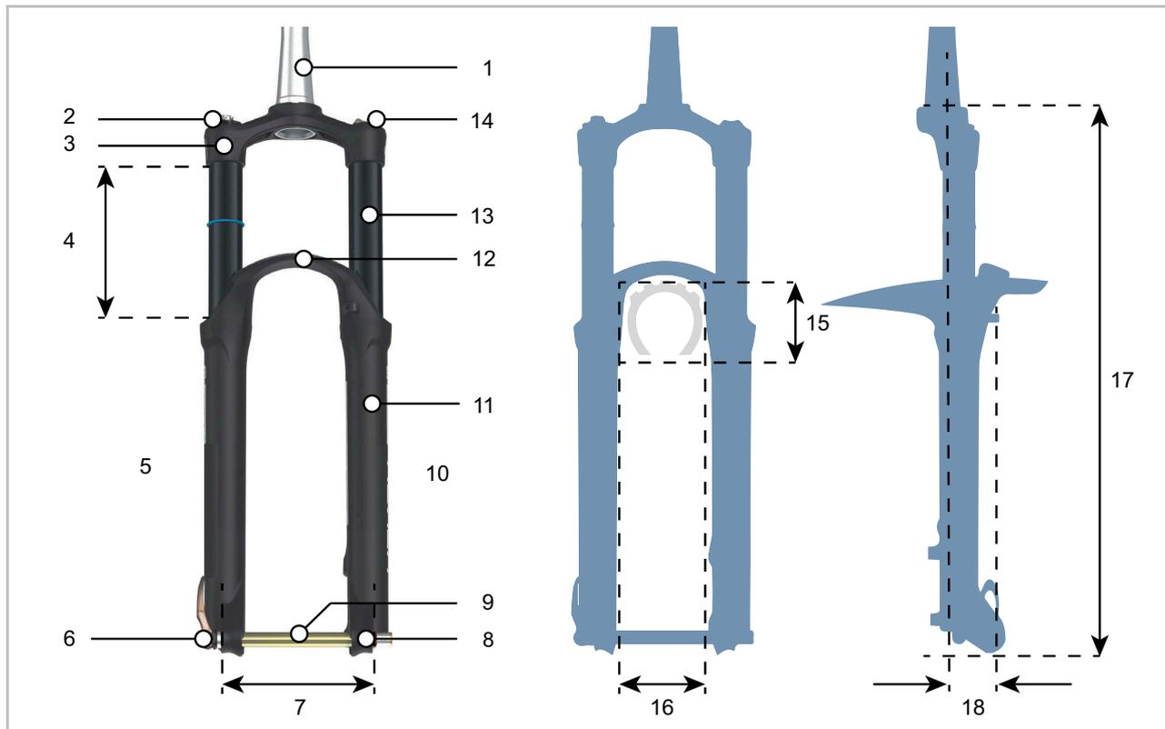
Illustration 9 : Structure d'une fourche de suspension
