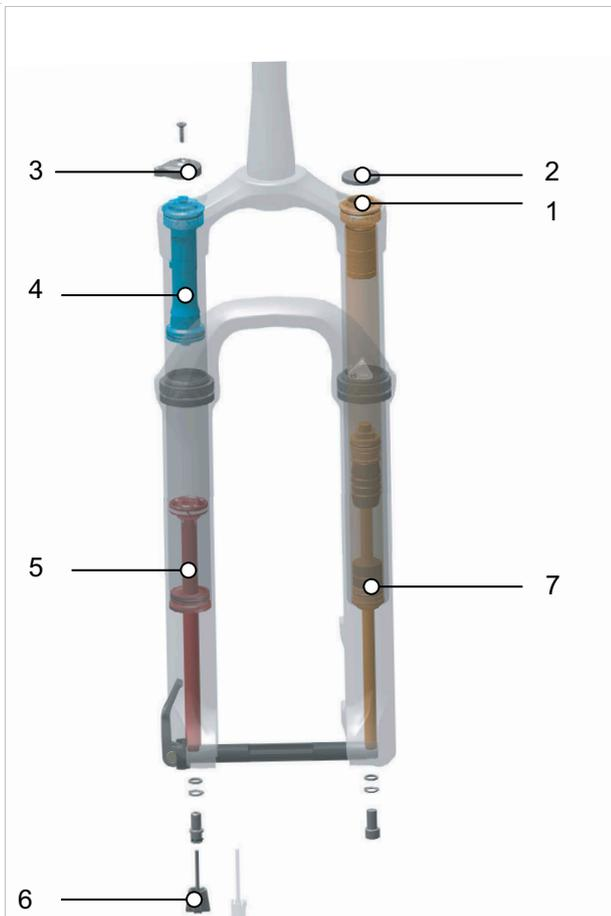
Illustration 10 : Structure interne d'une fourche de suspension pneumatique
