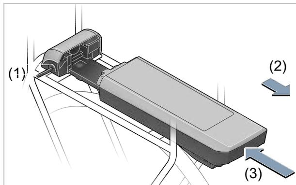
Illustration 115 : Retirer (2) et insérer (3) la batterie pour porte-bagages
