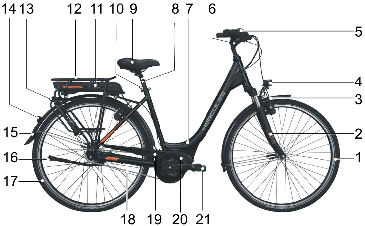
Illustration 3 : Vélo électrique vu de droite, exemple d'un HERCULES
