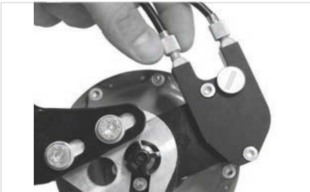
Illustration 164 : Sur les versions de moyeux ROHLOFF avec commande externe du changement de vitesse, le dispositif de réglage de la tension est situé sur le boîtier de câbles qui est placé sur le côté gauche
