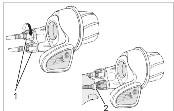
Illustration 166 : Poignée rotative avec douilles de réglage (1) avec jeu de rotation (2)
