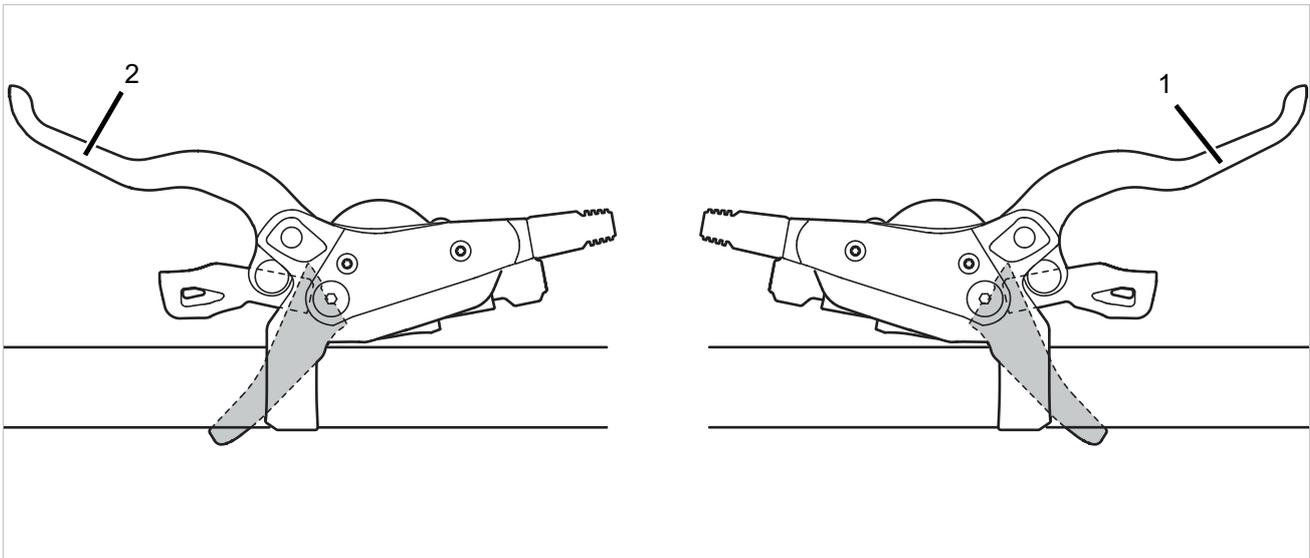
Illustration 49 : Freins à main arrière (1) et avant (2), exemple d'un frein SHIMANO
