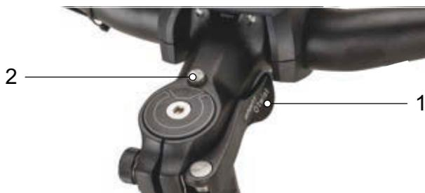
Illustration 139 : Potence, modèle II avec levier de serrage de l'attache rapide de la potence (1) et bouton de déblocage (2)
