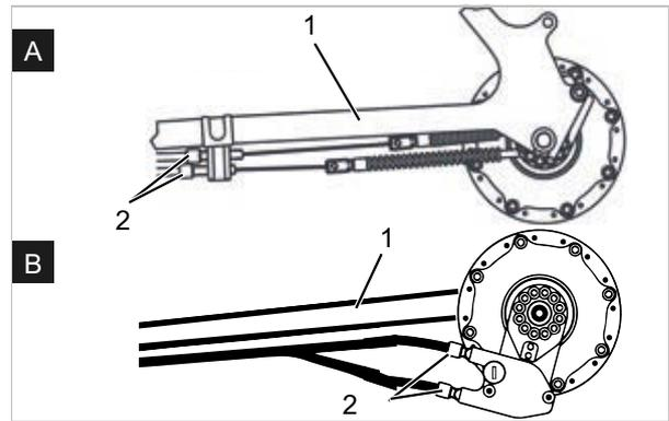
Illustration 165 : Douilles de réglage (2) sur deux modèles alternatifs (A et B) d'un changement de vitesse actionné par câble à deux câbles sur la base de cadre (1)
