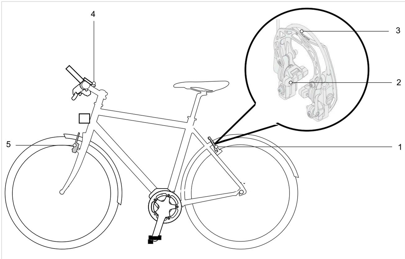
Illustration 30 : Système de frein avec frein de jante avec détails, exemple d'un MAGURA HS22
