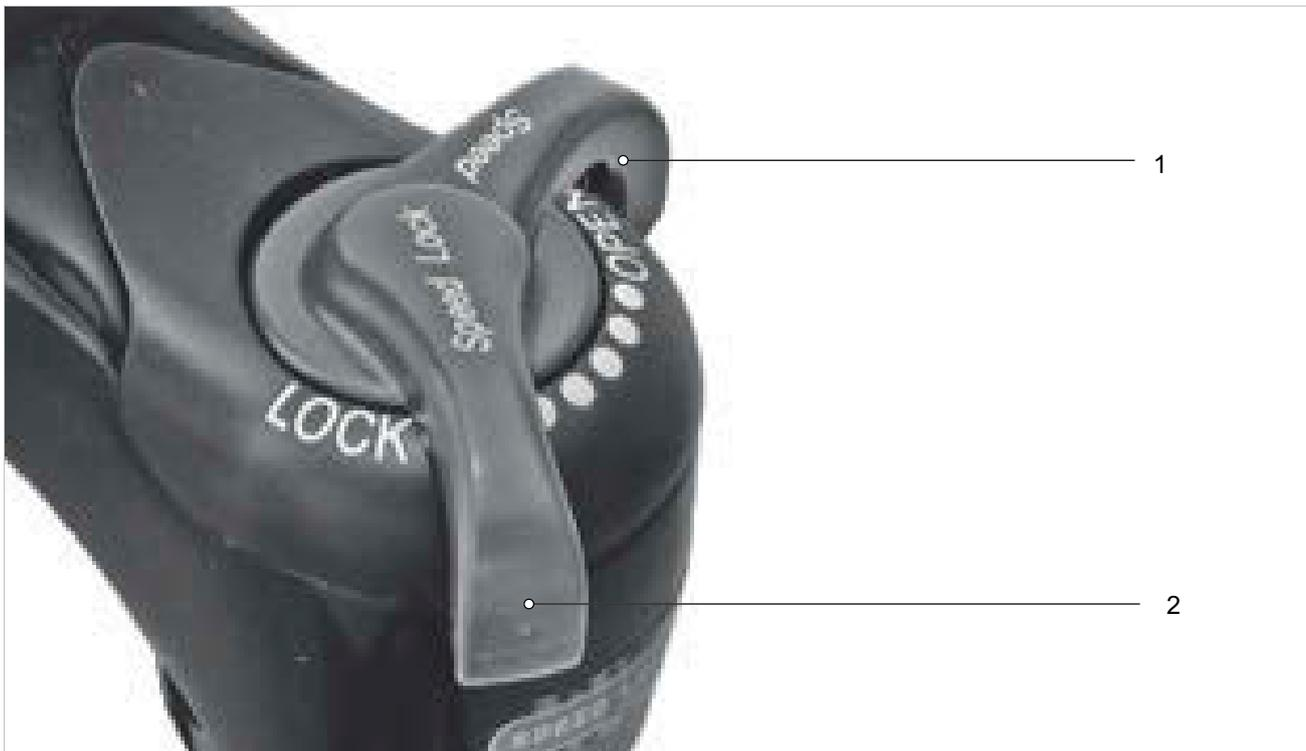
Illustration 135 : Amortisseur de compression SR SUNTOUR en position ouverte (1) et fermée (2)
