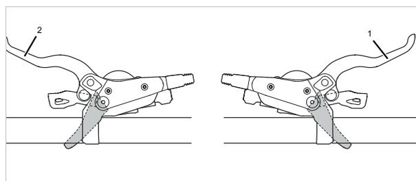
Illustration 130 : Frein à main arrière (1) et avant (2), exemple d'un frein SHIMANO
