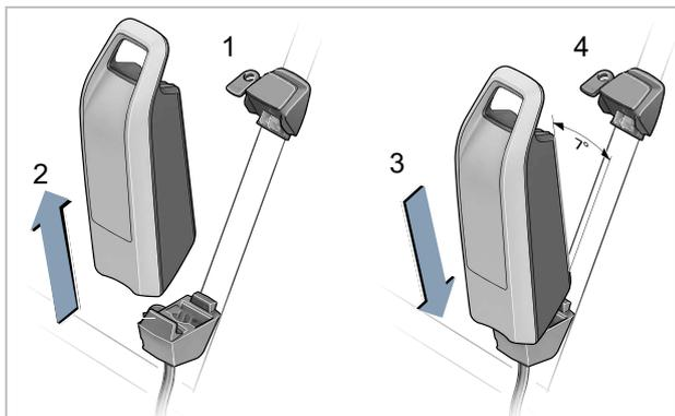
Illustration 114 : Retirer et insérer la batterie sur cadre
