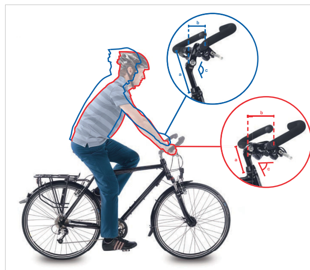
Abbildung 76: Citybike (blau) und Trekkingrad Position (rot) durch Winkeländerung
