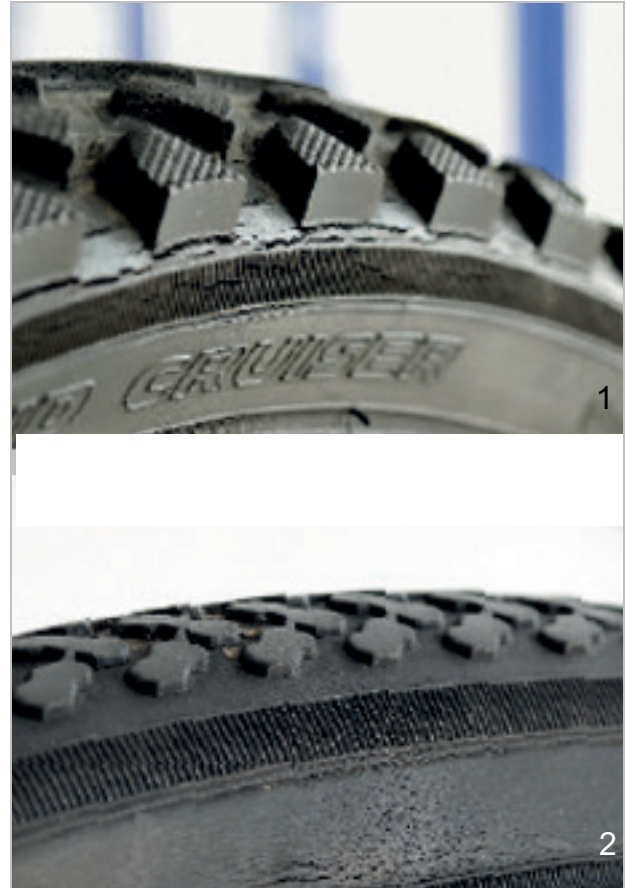
Abbildung 128: Beispiele für Ermüdungsrisse (1) und Alterungsrisse (2)
